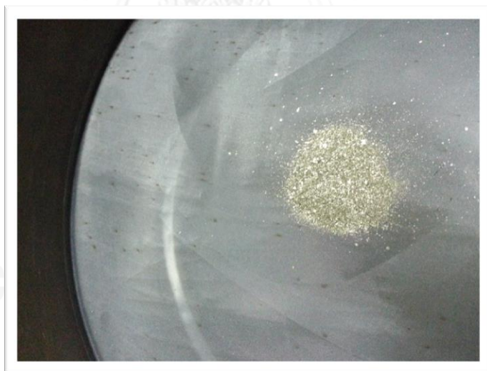
รูปที่ 3.5 ESM ที่มีขนาดใหญ่กว่า 75 ไมครอน (นำมาบดละเอียดซ้ำอีกครั้ง)
