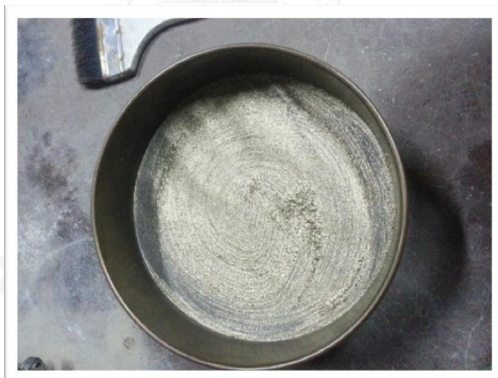
รูปที่ 3.3 การคัดขนาด ESM ด้วยตะแกรงขนาด -75 ไมครอน
