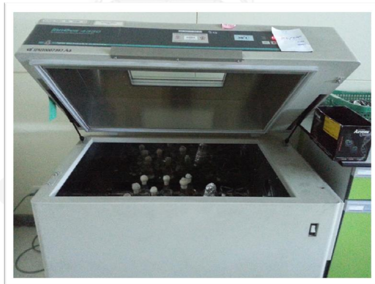
รูปที่ 3.9 เครื่องเขย่าควบคุมอุณหภูมิที่ 30 องศาเซลเซียส ความเร็ว 200 รอบต่อนาที
