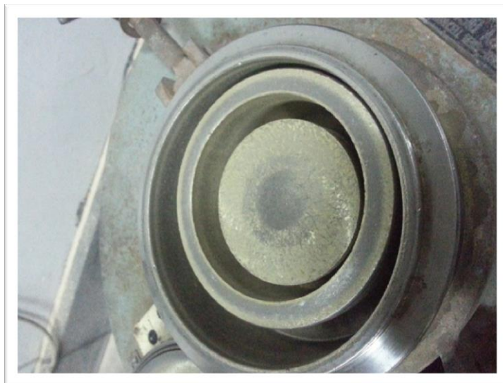
รูปที่ 3.2 การบดผงวงจรหลักของคอมพิวเตอรืด้วยเครื่องบดชนิด Vibratory cup mill
