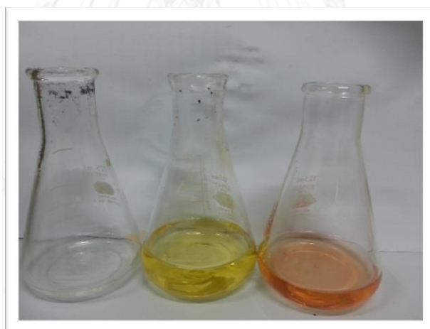
รูปที่ 3.11 การเปลี่ยนสีของอินดิเคเตอร์ ในการวิเคราะห์ความเข้มข้นของไซยาไนด์ด้วยวิธีไทเตรท (สีที่จุดยุติ-สีของอินดิเคเตอร์ก่อนการไทเตรท-ก่อนเติมอินดิเคเตอร์)
