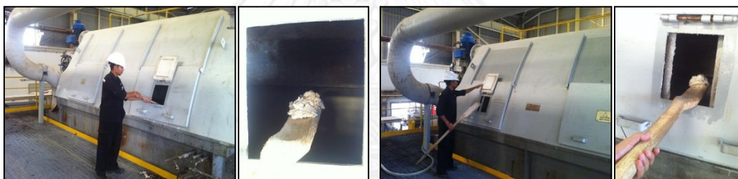
รูปที่ 1. 2 กระบวนการบีบล้างเยื่อ (Wash press) ของขั้นตอน EOP และ D1 ที่หน่วยงานฟอกเยื่อ
