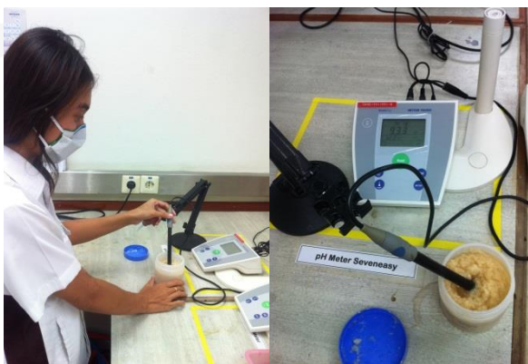
รูปที่ 3. 5 วิธีการวัดค่า pH ของตัวอย่างเยื่อ และเครื่อง pH meter ที่ใช้ในการวิเคราะห์
