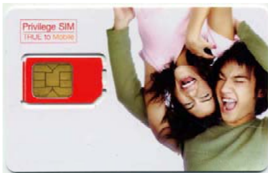
รูปที่ 2.15 ด้านที่มีขาสัญญาของซิมการ์ด
