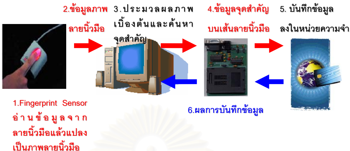
รูปที่ 3.8 ขั้นตอนการทำงานของระบบตรวจสอบลายนิ้วมือ กรณีต้องการลงทะเบียนลายนิ้วมือ
