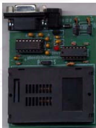
รูปที่ 4.15 เครื่องอ่าน/เขียนสมาร์ทการ์ด ที่ประกอบเสร็จเรียบร้อยแล้ว
