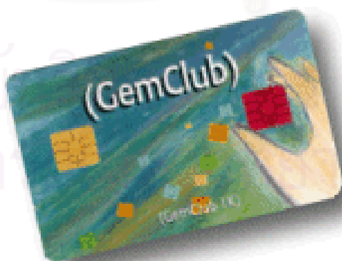
รูปที่ 2.22 ด้านหน้าของสมาร์ทการ์ดแบบมีหน้าสัมผัส
