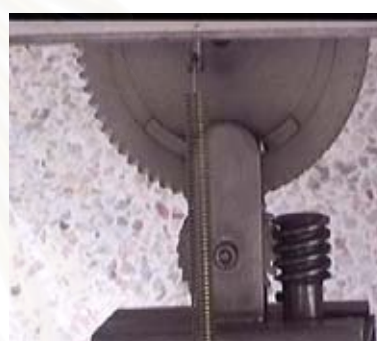
(ค) ระบบควบคุมการหมุนรอบแกนยก
