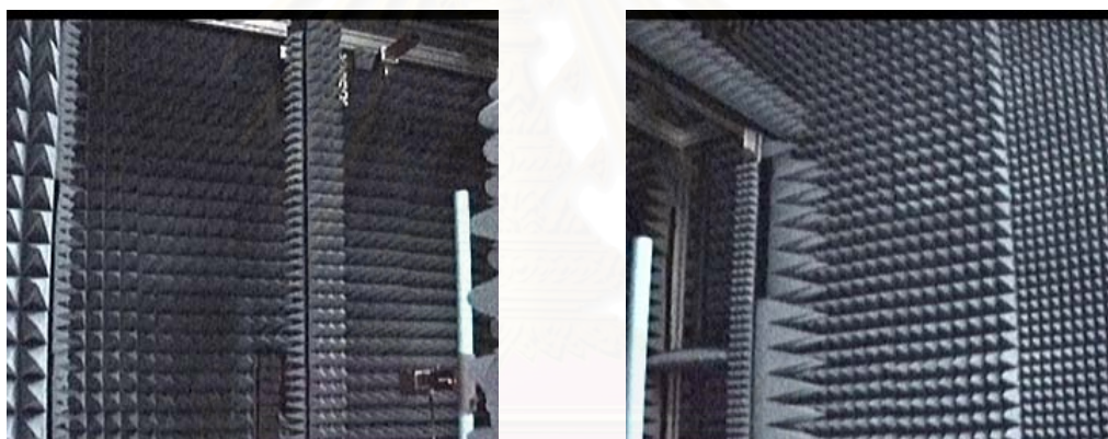
รูป 4.5 สภาพภายในห้องทดสอบและระนาบกวาดวัดของ การทดสอบสายอากาศย่านสนามใกล้เชิงระนาบ
