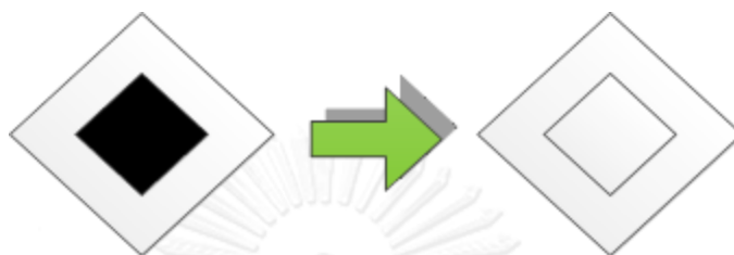
รูปที่ 2-3 แก่นของรูปสี่เหลี่ยมสีดำ และสี่เหลี่ยมสีขาวของกระบวนการแบบฮาร์
