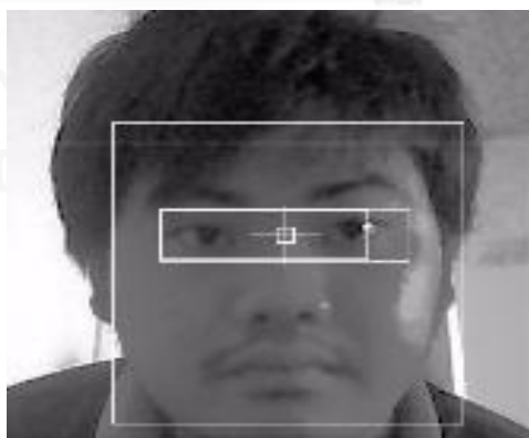
รูปที่ 2-7 วิธีการแบบฮาร์ที่ตรวจจับดวงตาทั้งสองข้าง
