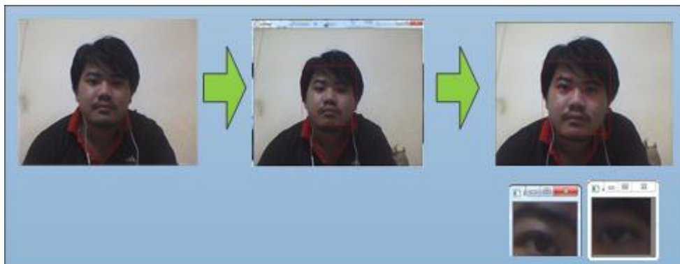
รูปที่ 2-6 กระบวนการวิธีตรวจจับใบหน้า และดวงตาด้วยกระบวนการวิธีแบบฮาร์
