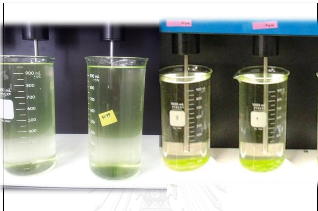
ภาพที่ 4-14 การแยกอนุภาคสาหร่ายด้วยวิธีจาร์เทส ด้วยสารโคแอกกูแลนต์ต่างชนิดกัน ด้านซ้าย : แคลเซียมคลอไรด์ ด้านขวา : สารส้ม
