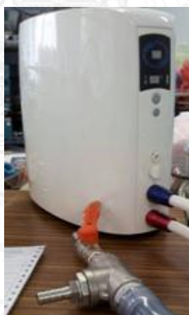
ภาพที่ 4-25 เครื่องสร้างฟองอากาศขนาดเล็กด้วยความดัน 4 บาร์
