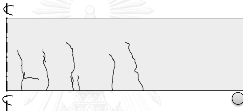
รูปที่ 4-15 แสดงการแตกร้าว (crack) น้ำหนักที่กด 20 ตันของหน้าตัด SRC
