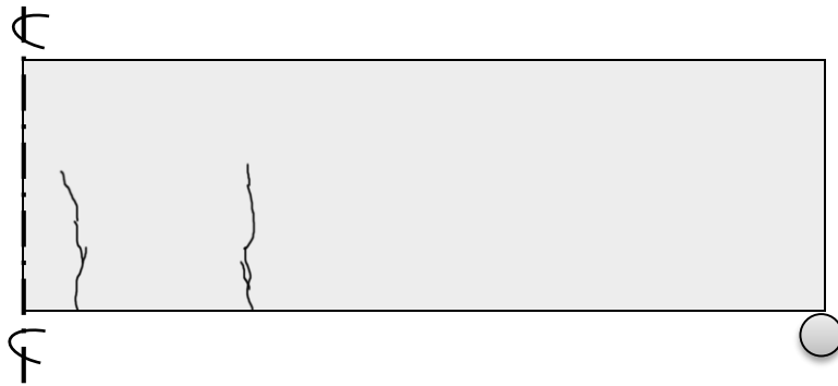
รูปที่ 4-14 แสดงการแตกร้าว (crack) น้ำหนักที่กด 10 ตันของหน้าตัด SRC
