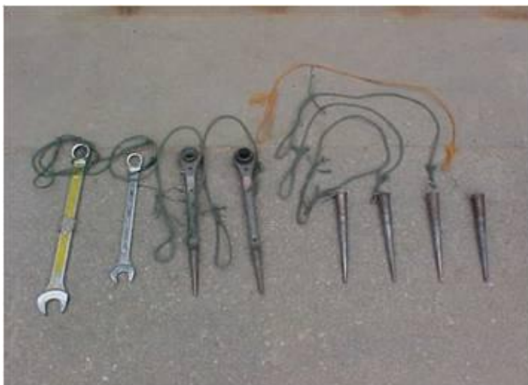
ภาพที่ 9 แสดงเชือกผูกมัดเครื่องมือ และอุปกรณ์ที่ใช้ในการทำงาน
