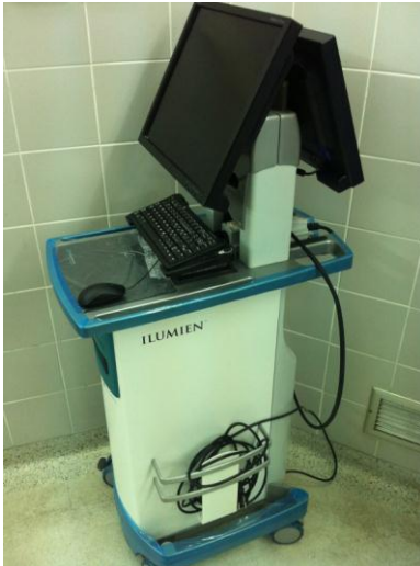
ภาพที่ 3.2แสดงอุปกรณ์ในการวัด Optical Coherence Tomography (OCT) ;รุ่น ILUMIE ของบริษัท ST. Jude Medical
