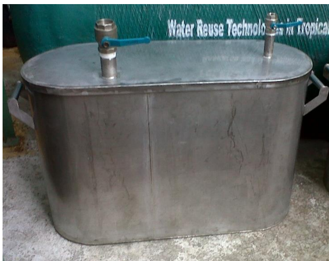
ภาพที่ 3.1 ถังปฏิกรณ์ชีวภาพเมมเบรนแบบคลองวนเวียนที่ใช้ในการทดลอง
