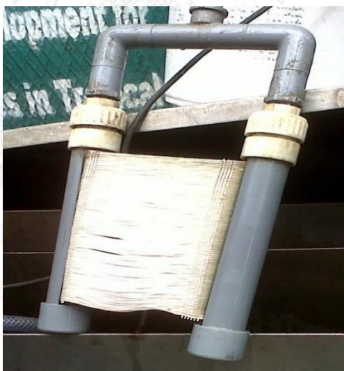
ภาพที่ 3.2 ไมโครฟิลเตรชันเมมเบรนแบบเส้นใยกลวง
