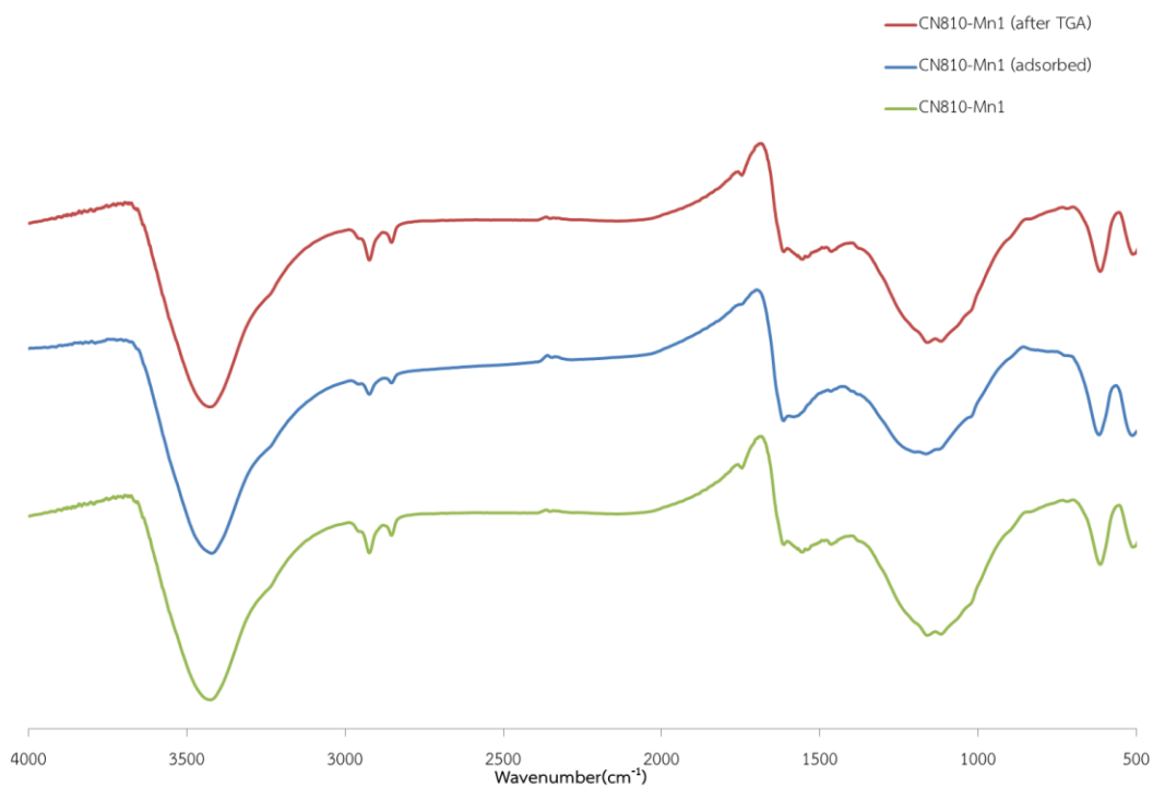
Fig. 29 (d) FTIR spectra of CN810-Mn1
