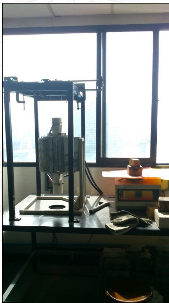
ภาพที่ 17 แสดงการอบชิ้นงานเหล็กชุบสังกะสีแบบจุ่มร้อนโดยใช้เตาท่อแบบตั้ง
