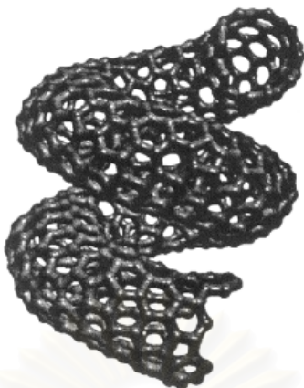
รูปที่ 8 โครงสร้างขดสปริงของคาร์บอนนาโนทิวบ์(Harris, 1999)
