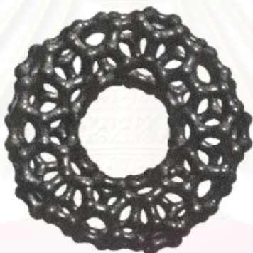
รูปที่ 9 โครงสร้างโดนัทของคาร์บอนนาโนทิวบ์(Harris, 1999)
