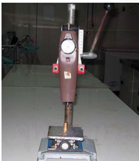
รูปที่ ง.4: เครื่องมือวัดความแน่นเนื้อ และขนาดหัววัดแรงกดขนาด 2, 5, 8 และ 10 มิลลิเมตร
