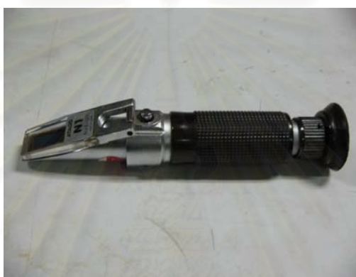
รูปที่ ง.5: Hand refractometer ที่ใช้ในการทดลอง
