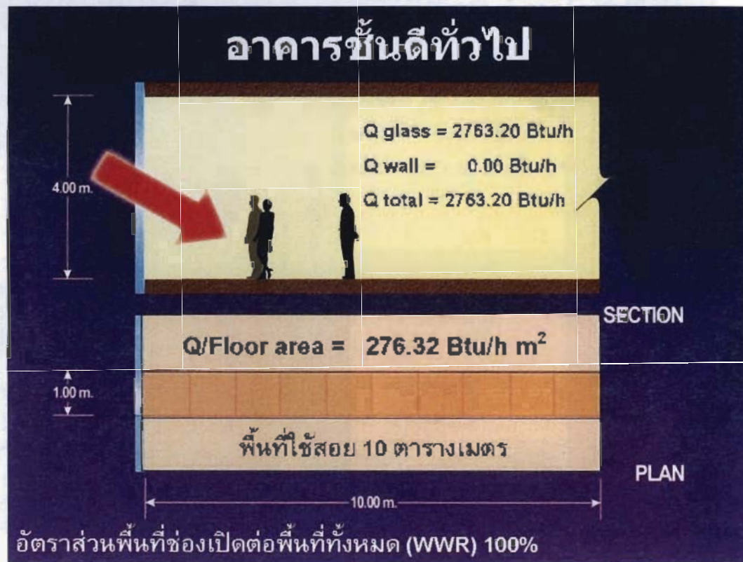
ภาพที่ 49 การคำนวณภาระการทำความเย็นสูงสุดของเปลือกอาคาร ยุคอุตสาหกรรม (Control สบายตลอดเวลา)
