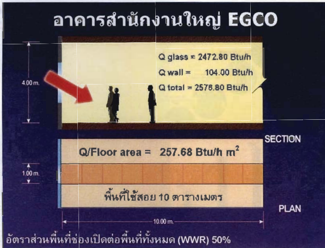
ภาพที่ 50 การคำนวณภาระการทำความเย็นสูงสุดของเปลือกอาคารยุคเทคโนโลยีสารสนเทศ
