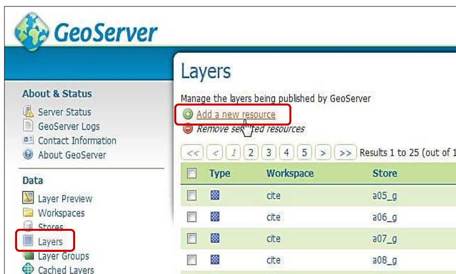
ภาพที่ ข.1 การสร้าง Layer ใหม่ใน GeoServer
