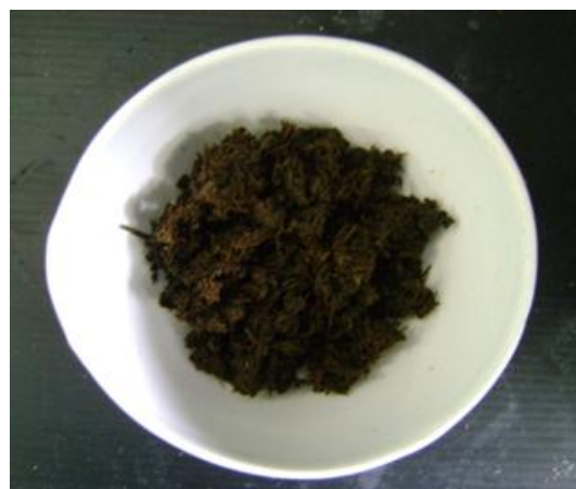
ภาพที่ 4.4 ข้าวโพดที่ผ่านการปรับสภาพ โดยการให้ความร้อน
