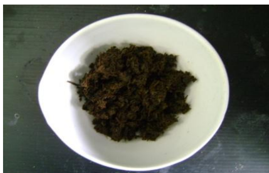
ภาพที่ 3.5 ต้นข้าวโพดที่ผ่านการปรับสภาพเบื้องต้นด้วยการลดขนาดแล้วนำไปนึ่งด้วยหม้อนึ่งความดันสูง (Autoclave) ที่อุณหภูมิ 180 องศาเซลเซียส
