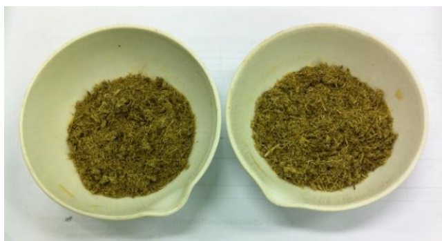
ภาพที่ 3.4 ต้นข้าวโพดที่ผ่านการปรับสภาพเบื้องต้นด้วยการลดขนาดและแช่ในสารละลายต่างชนิดเดียวไฮดรอกไซด์
