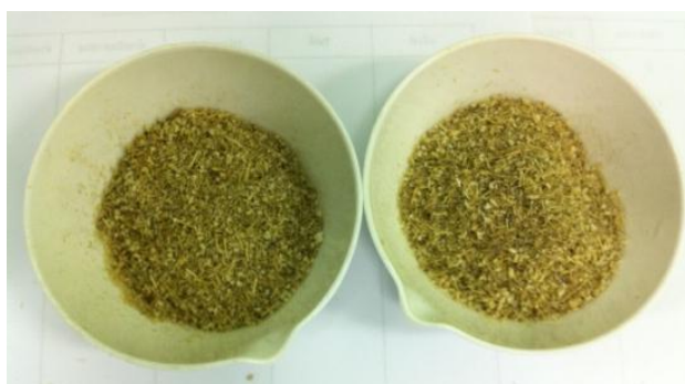
ภาพที่ 3.3 ต้นข้าวโพดที่ผ่านการบดให้ละเอียด โดยให้มีขนาดเส้นผ่านศูนย์กลาง ประมาณ 2 มิลลิเมตร
