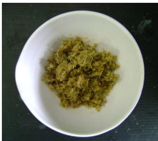
ภาพที่ 4.3 ข้าวโพดที่ผ่านการปรับสภาพ โดยใช้สารละลายต่าง
