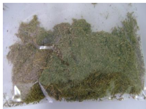
ภาพที่ 4.2 ต้นข้าวโพดที่มีการปรับปรุงสภาพ โดยการลดขนาด
