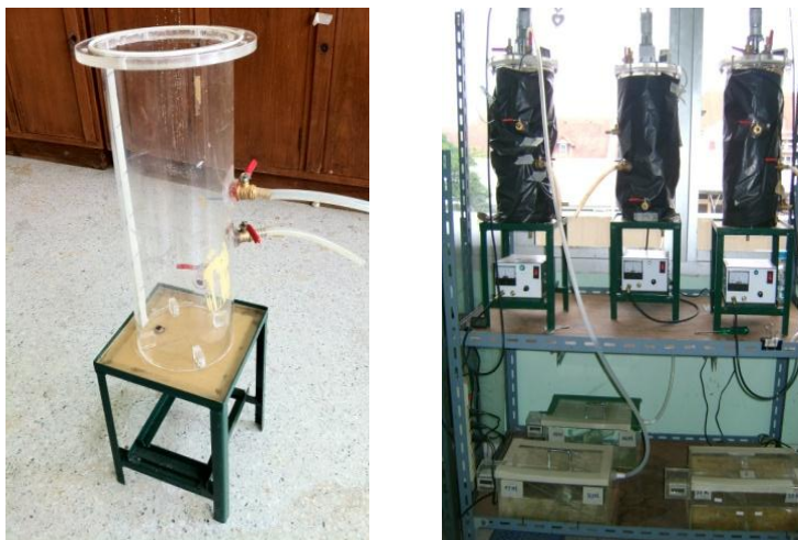
ภาพที่ 3.7 ถังหมักไร้ออกซิเจนแบบกวนสมบูรณ์ที่ใช้ในการทดลอง
