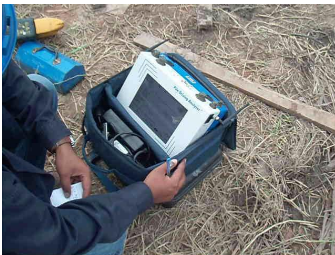
รูปที่ 3-4 การทดสอบด้วยPile Driving Analyzer (PDA)
