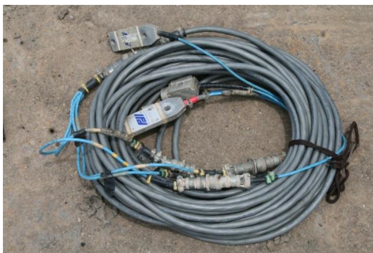
รูปที่ 4-9 มาตรฐานสัญญาณการทดสอบ PDA ชนิดสายเคเบิล
