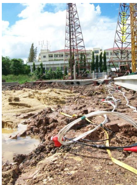
รูปที่ 3-2 การตรวจวัดความไหวสะเทือนจากการตอกเสาเข็มที่ผิวดิน
