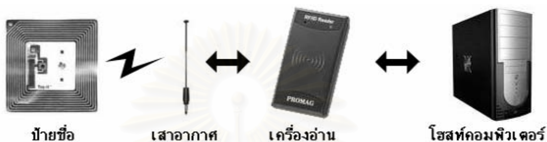
รูปที่ 1 – ระบบโดยรวมของอาร์เอฟไอดี [2][11]
