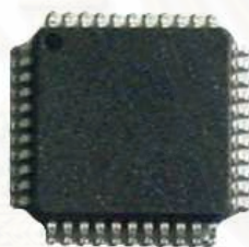
รูปที่ 16 – หีบห่อแบบ TQFP ของไมโครคอนโทรลเลอร์ P89V51RD2 [19]
