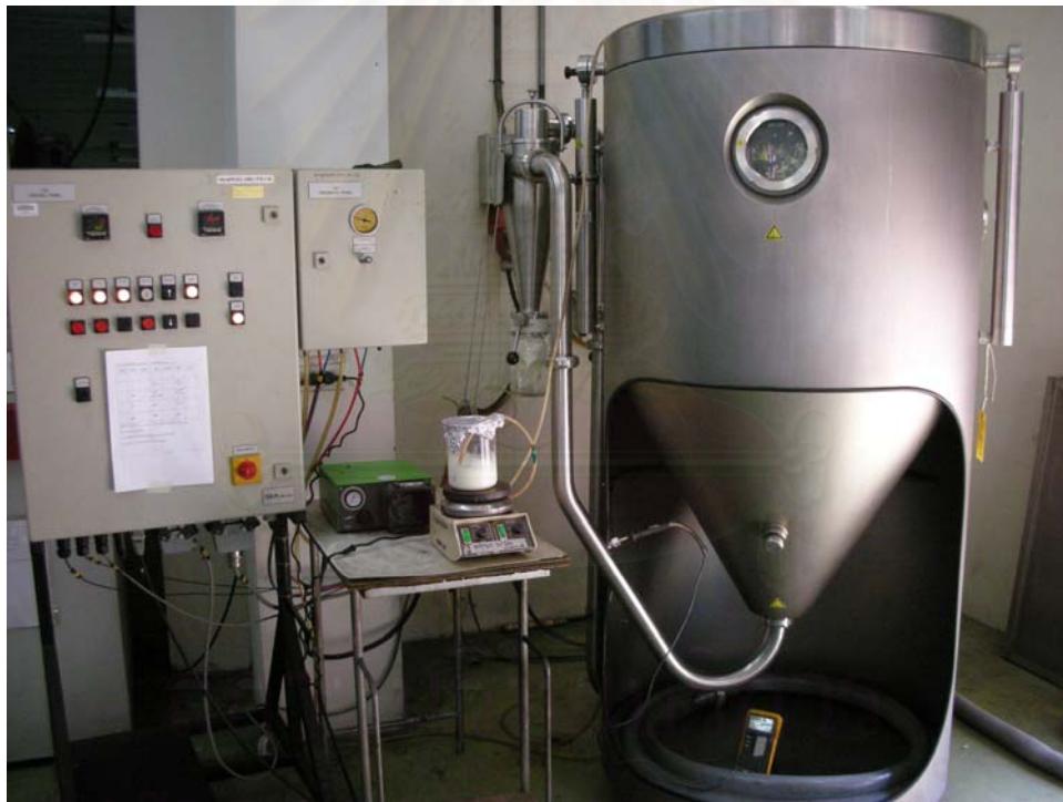
รูปที่ 3-ก เครื่องทำแห้งแบบพ่นฝอย (Spray dryer)
