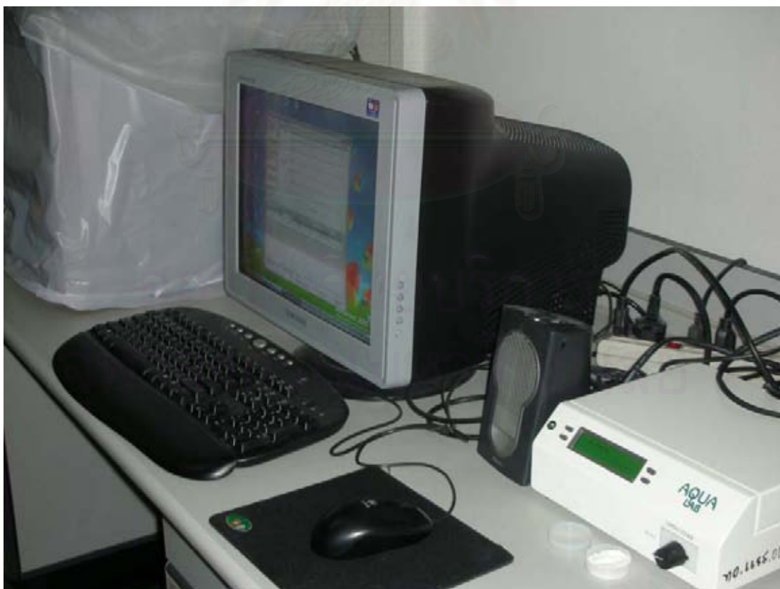
รูปที่ 2-ก เครื่องมือวิเคราะห์ค่า Water activity ( a_w analyzer)
