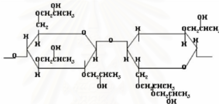
รูปที่ 3.3 สูตรโครงสร้าง HPC
