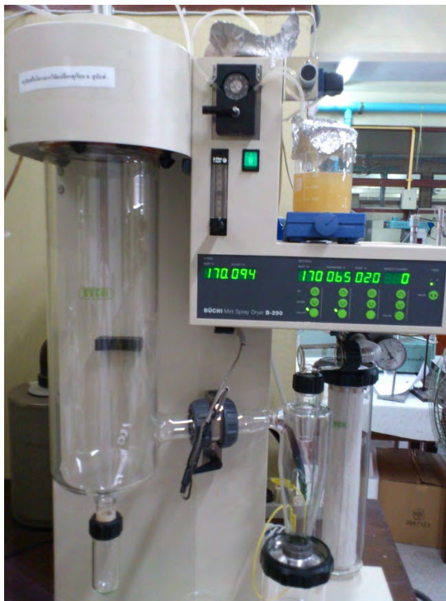
รูปที่ 3 แสดงเครื่องพ่นแห้งรุ่น BÜCHI Mini Spray Dryer B-290
