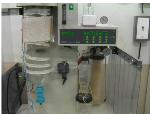
รูปที่ 3.1 เครื่องอบแห้งแบบพ่นฝอยที่ติดตั้งเครื่องทำความร้อนกับปั๊มสุญญากาศ
