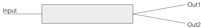
รูปที่ 5.1 ลักษณะของตัวคู่ต่อสัญญาณทางแสง
