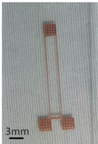
ภาพที่ 3.7 โครงสร้างทองแดงลอยตัวที่งานวิจัยนี้ได้ทำการสร้างขึ้น
