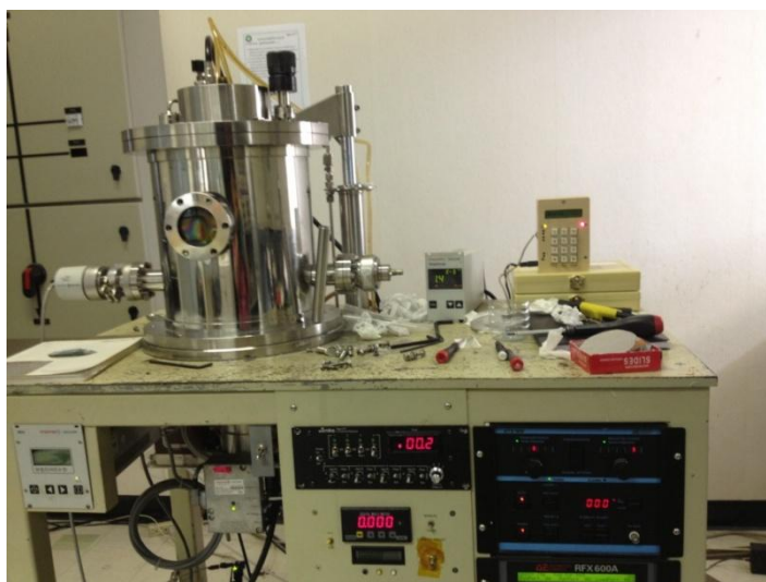
ภาพที่ ก.12 เครื่องสเปตเตอริงที่ใช้ในกระบวนการเคลือบผิวด้วยนิทินอล ณ ศูนย์เทคโนโลยีอิเล็กทรอนิกส์และคอมพิวเตอร์แห่งชาติ
