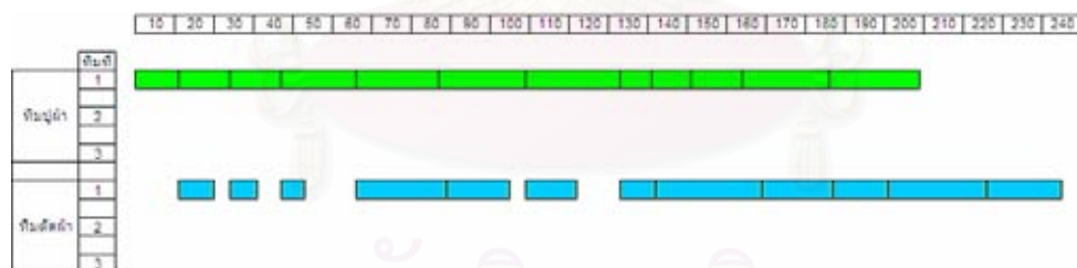
รูปที่ ข-1 แผนภูมิแกนต์การจัดตารางการปูผ้าและการตัดผ้าด้วยทีมปูผ้า 1 ทีม และทีมตัดผ้า 1 ทีม
