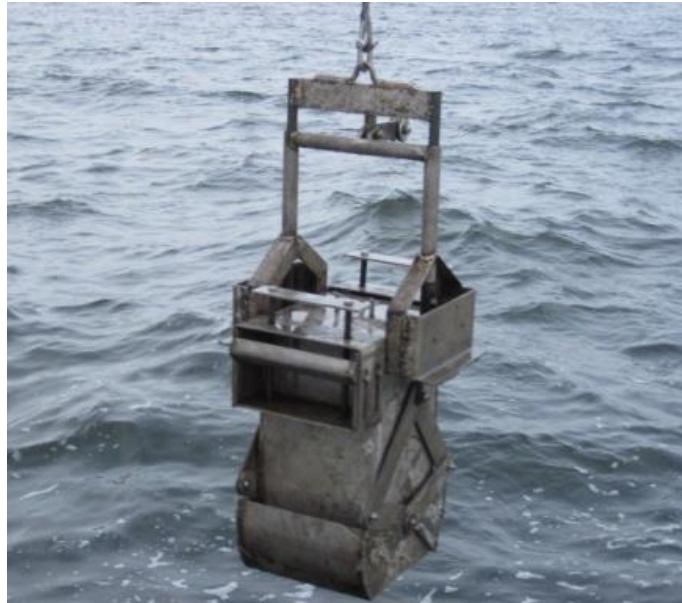
รูปที่ 3-2 อุปกรณ์ที่ใช้เก็บดินตะกอน (Box Corer)
