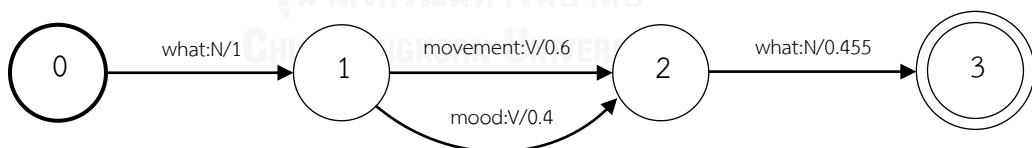
ภาพที่ 5-15 ตัวอย่างโครงข่ายตัวเปลี่ยนแปลงสถานะจำกัดแบบถ่วงน้ำหนักจากแบบจำลองของหมวดหมู่หลัก
