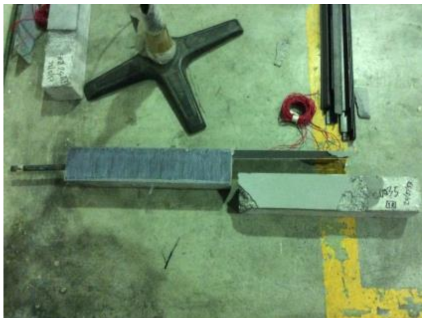
รูปที่ จ-34 การวิบัติที่ตัวอย่างคอนกรีต F35-32
