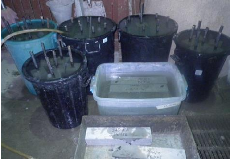
รูปที่ ข-5 การบ่มคอนกรีต
