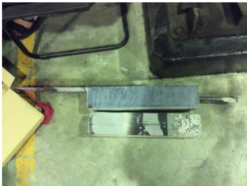
รูปที่ จ-21 การวิบัติที่ตัวอย่างคอนกรีต D35-2
