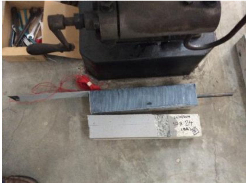
รูปที่ จ-20 การวิบัติที่ตัวอย่างคอนกรีต C24-32
