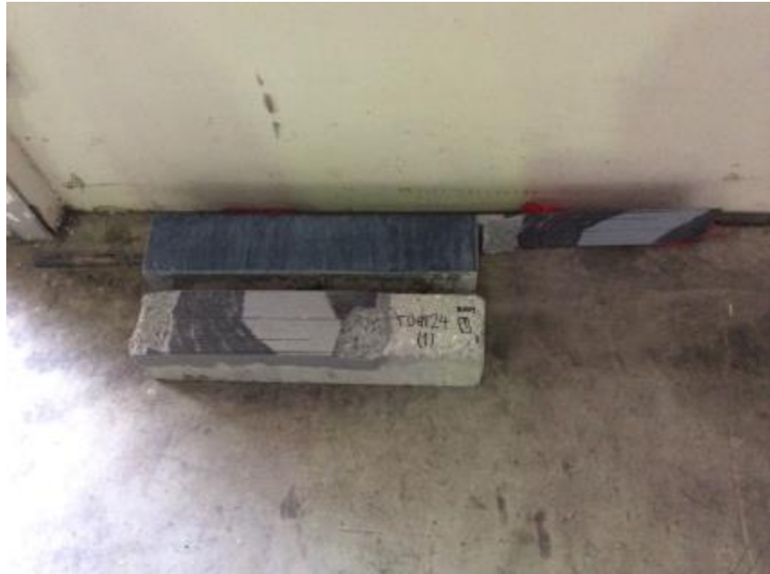
รูปที่ จ-1 การวิบัติที่ตัวอย่างคอนกรีต A24-2
