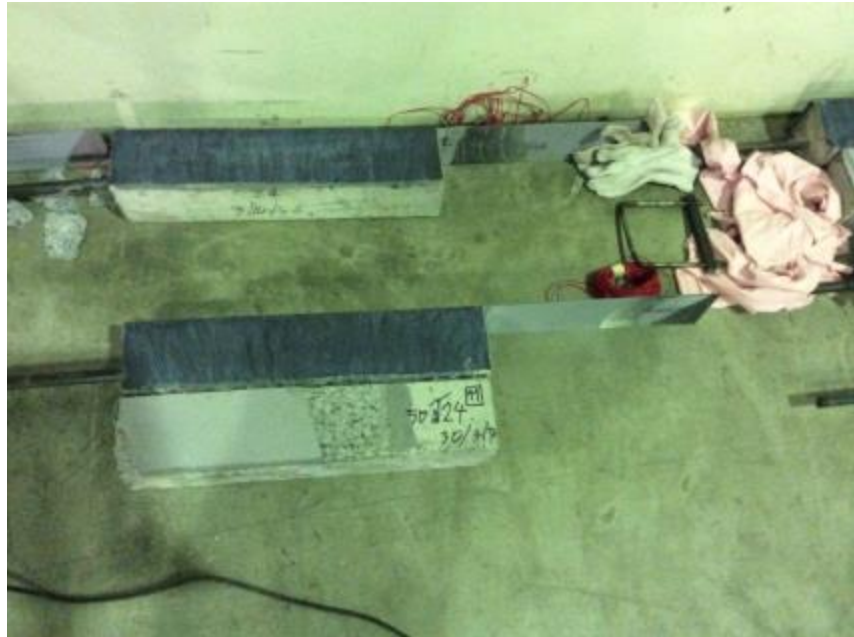
รูปที่ จ-19 การวิบัติที่ตัวอย่างคอนกรีต C24-24
