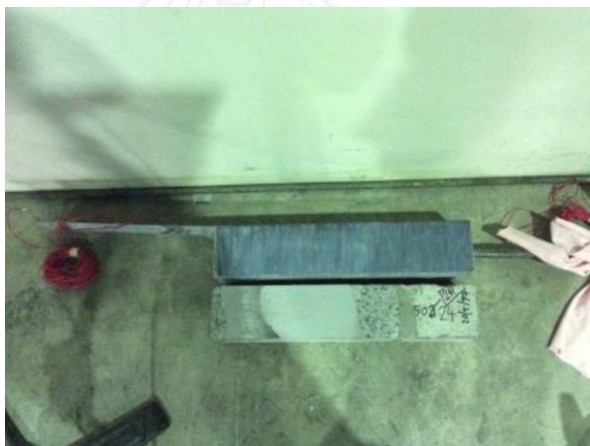
รูปที่ จ-12 การวิบัติที่ตัวอย่างคอนกรีต B35-32
