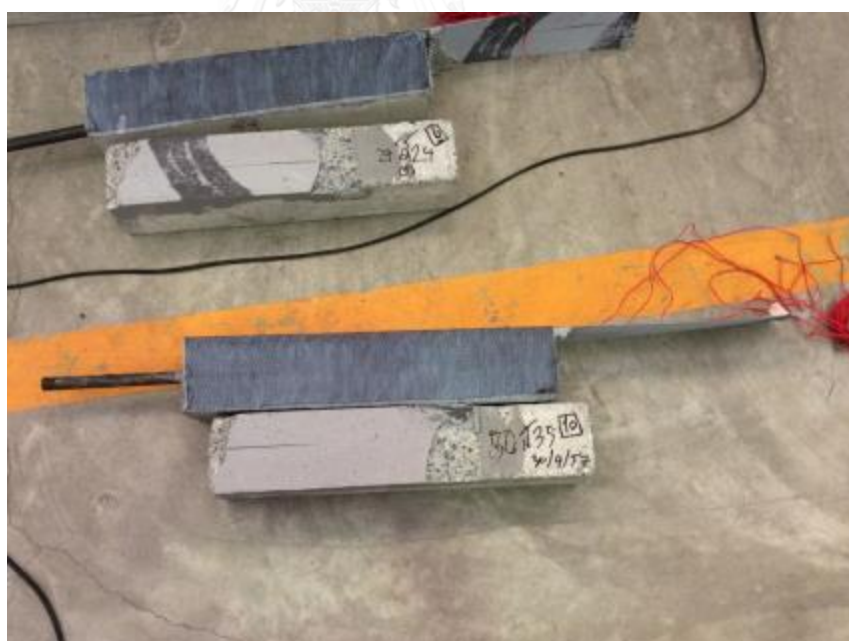
รูปที่ จ-22 การวิบัติที่ตัวอย่างคอนกรีต D35-12
