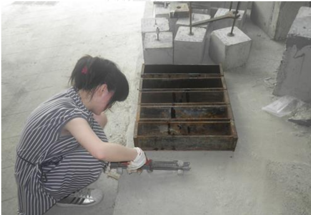
รูปที่ ข-2 เตรียมเหล็กเสริม
