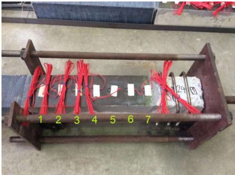
รูปที่ 4.3 ตำแหน่งติดตั้งอุปกรณ์วัดความเครียดบนวัสดุพอลิเมอร์แบบแผ่น
