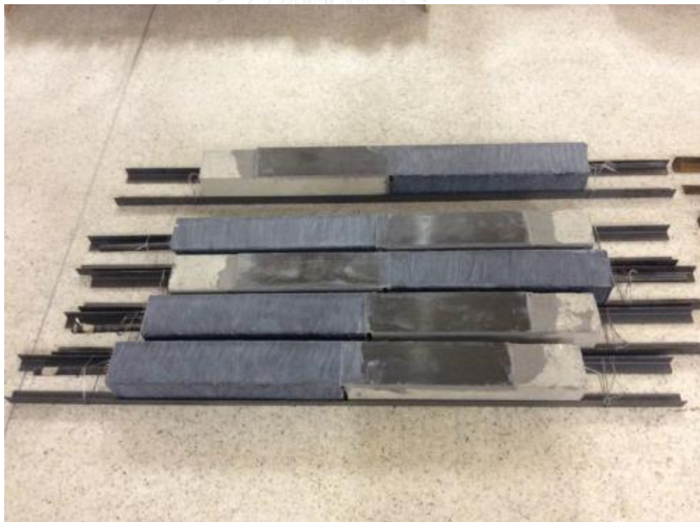
รูปที่ ข-14 การWrapตัวอย่างคอนกรีตบนด้านที่ไม่ทดสอบ
