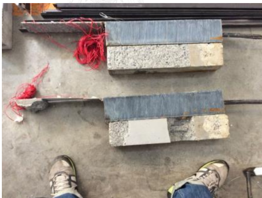
รูปที่ จ-31 การวิบัติที่ตัวอย่างคอนกรีต E24-32
