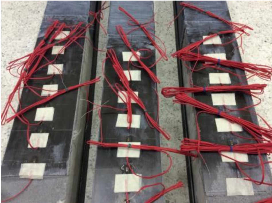
รูปที่ ข-17 การติดตั้ง Strain Gauge หลังจากทดสอบควบคุมอุณหภูมิและความชื้นตามที่กำหนด
