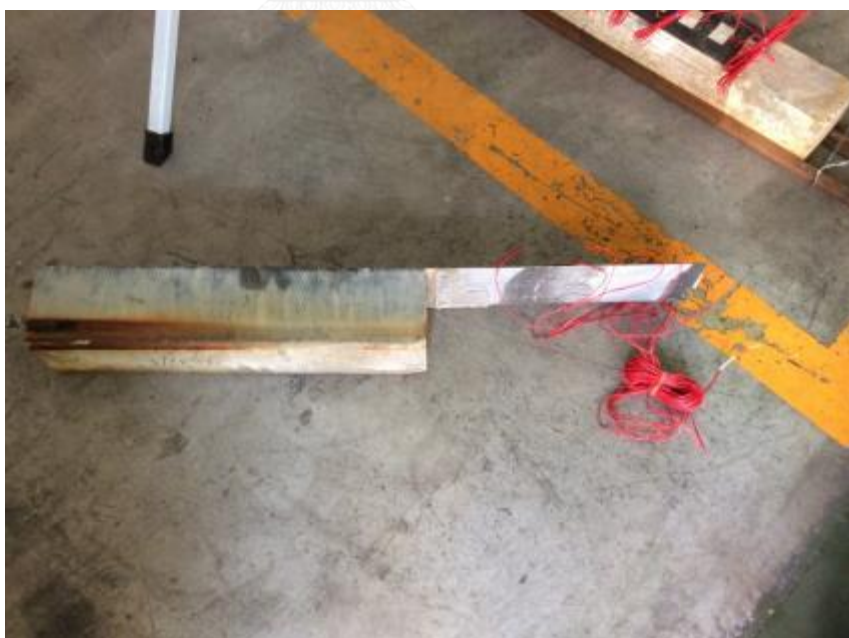
รูปที่ จ-35 การวิบัติที่ตัวอย่างคอนกรีต G24-32
