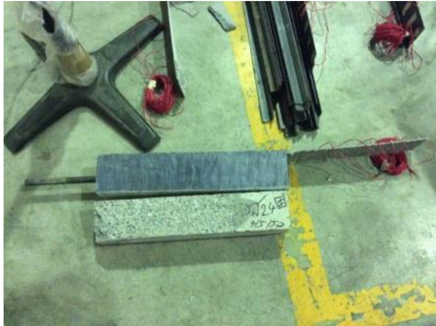
รูปที่ จ-15 การวิบัติที่ตัวอย่างคอนกรีต C24-6
