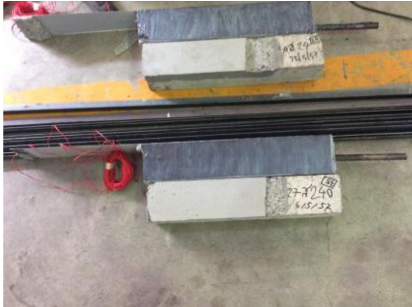
รูปที่ จ-25 การวิบัติที่ตัวอย่างคอนกรีต E24-4
