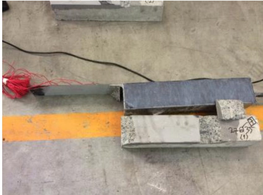
รูปที่ จ-16 การวิบัติที่ตัวอย่างคอนกรีต C24-8
