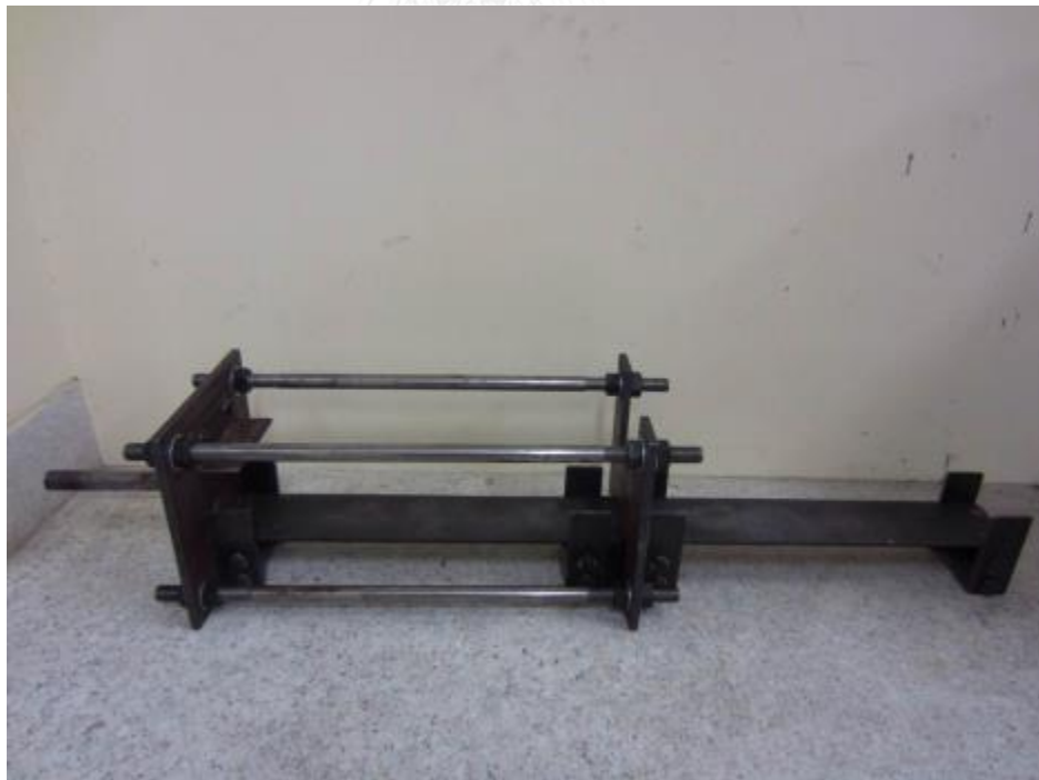
รูปที่ ข-18 แท่นตั้งตัวอย่างคอนกรีตที่ติดตั้ง CFRP
