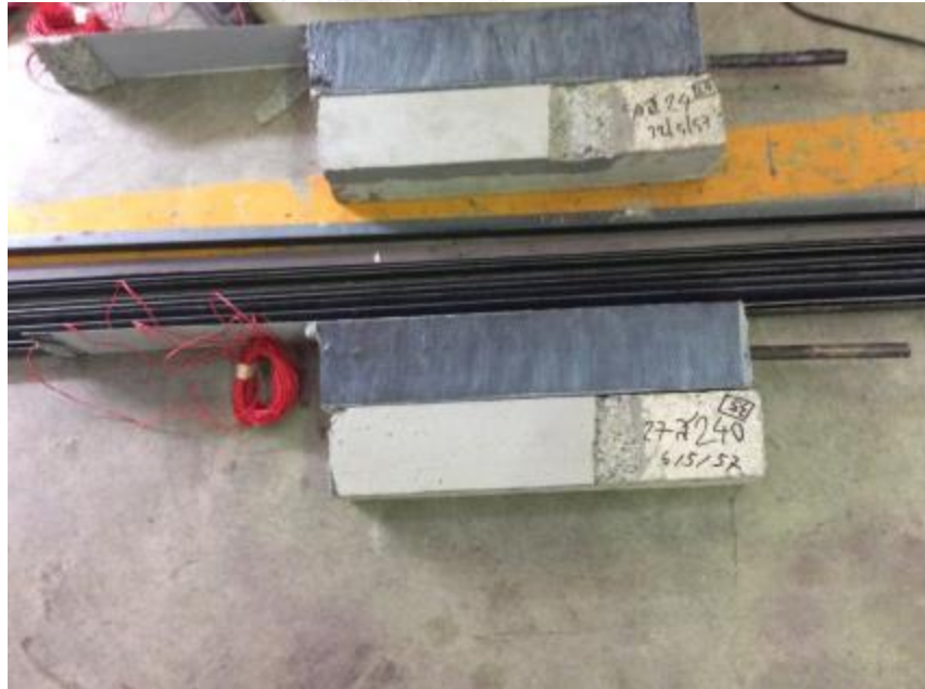
รูปที่ จ-29 การวิบัติที่ตัวอย่างคอนกรีต E24-16
