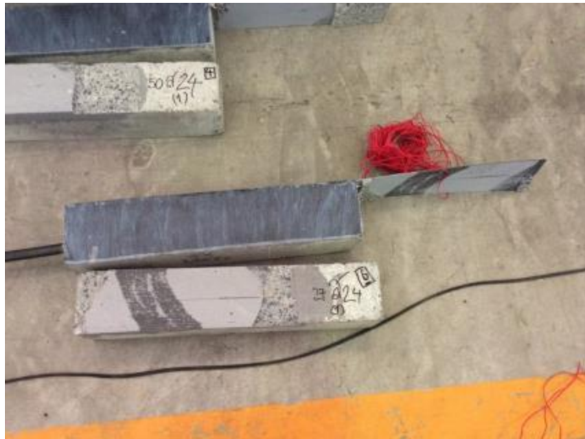
รูปที่ จ-7 การวิบัติที่ตัวอย่างคอนกรีต A24-24
