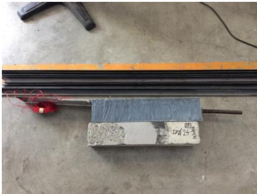
รูปที่ จ-30 การวิบัติที่ตัวอย่างคอนกรีต E24-24
