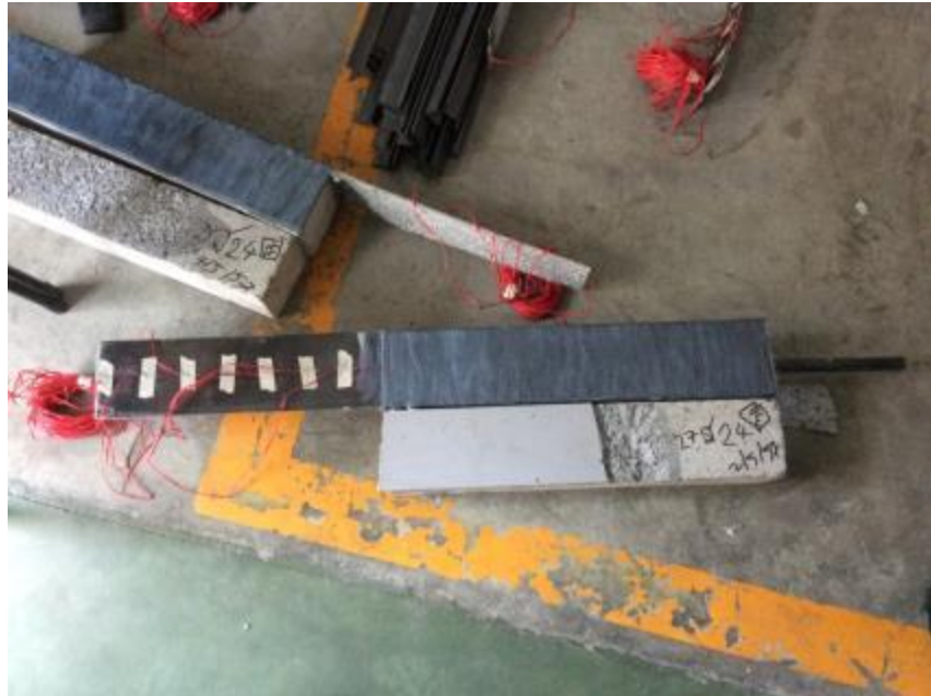
รูปที่ จ-28 การวิบัติที่ตัวอย่างคอนกรีต E24-12
