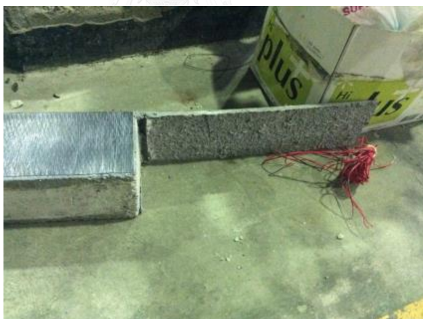
รูปที่ จ-41 การวิบัติที่ขึ้นตัวอย่าง I24-48
