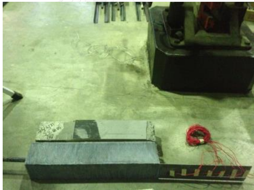
รูปที่ จ-8 การวิบัติที่ตัวอย่างคอนกรีต A24-32
