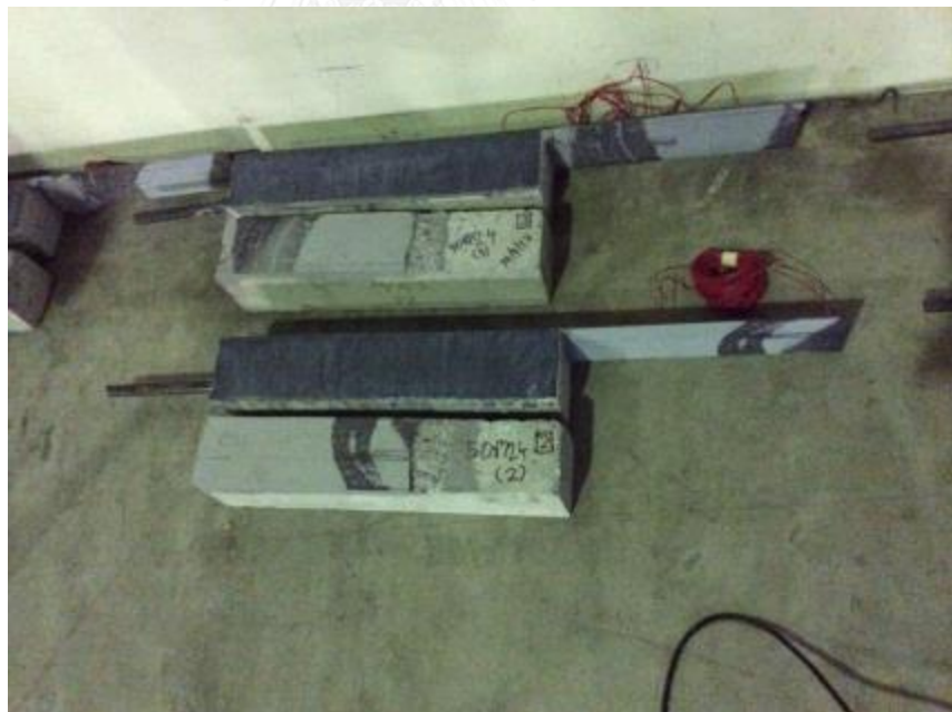
รูปที่ จ-2 การวิบัติที่ตัวอย่างคอนกรีต A24-4
