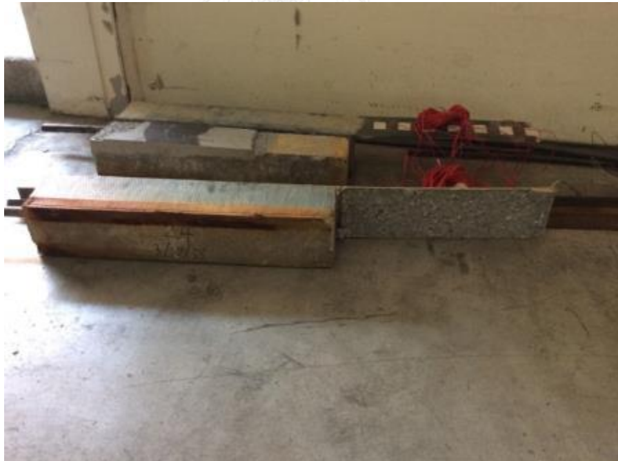
รูปที่ ข-20 ตัวอย่างคอนกรีตหลังจากการทดสอบ
