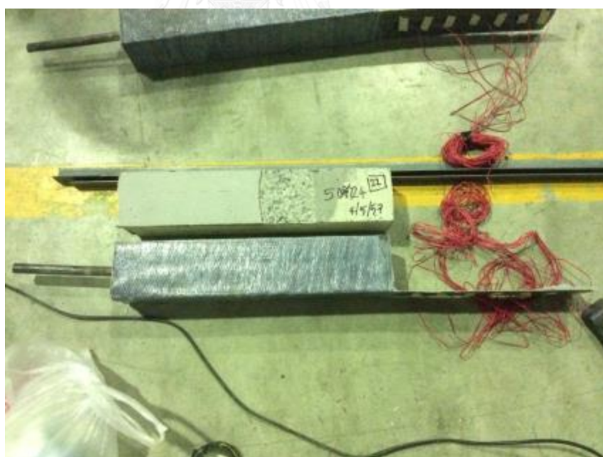
รูปที่ จ-18 การวิบัติที่ตัวอย่างคอนกรีต C24-16
