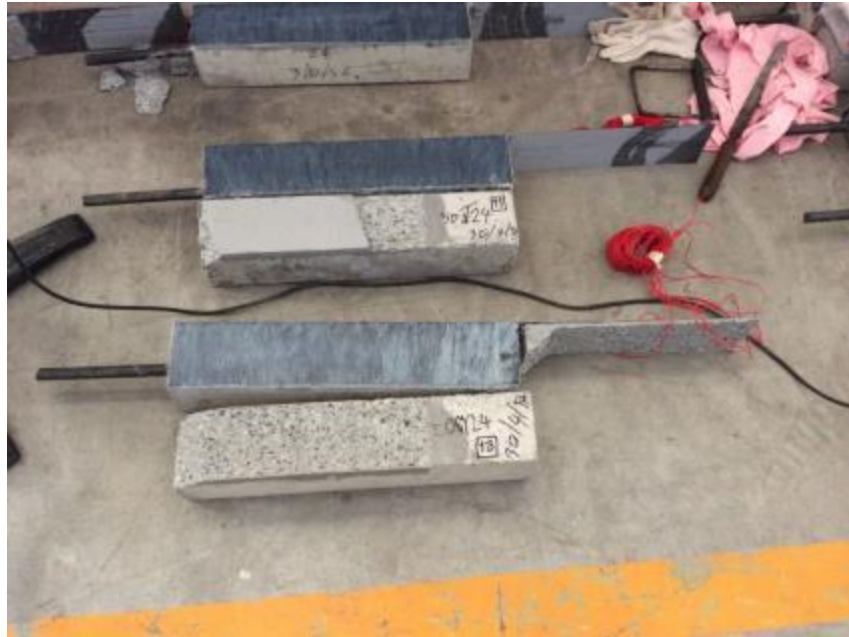
รูปที่ จ-24 การวิบัติที่ตัวอย่างคอนกรีต E24-2
