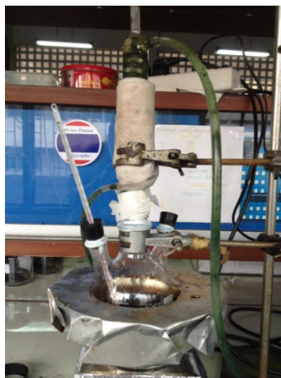
ภาพที่ 3.1 การจัดตั้งขวดสามคอขณะสังเคราะห์ตัวเร่งปฏิกิริยานิกเกิลแกน
