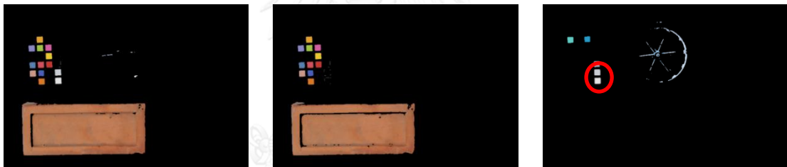
ภาพที่ 4.7 การแบ่งส่วนโดยใช้จำนวนกลุ่มที่มากขึ้นซึ่งส่งผลกับค่าความผิดพลาดของอิฐ
