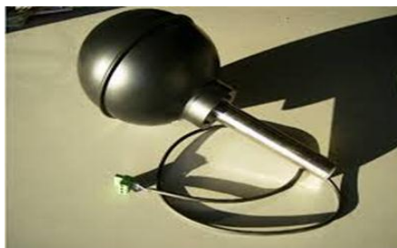
ภาพที่ 3. 40 Globe Thermometer คือ เครื่องมือวัดแบบ Digital Thermo-Hygrometer
