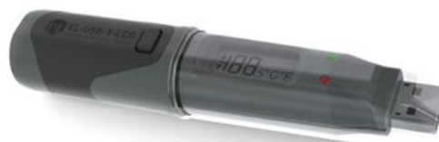
ภาพที่ 3. 36 แสดงเครื่องมือที่ใช้ในการเก็บข้อมูลอุณหภูมิอากาศและความชื้นสัมพัทธ์ ตลอด ชั่วโมง 24ง
