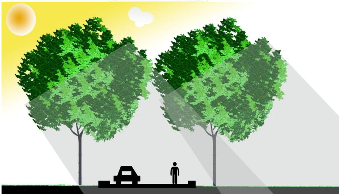
ภาพที่ 4. 2 แสดงการลดการแผ่รังสีจากถนนโดยการใช้ร่มเงาของต้นไม้สกัดกั้นรังสีความร้อนจากดวงอาทิตย์
