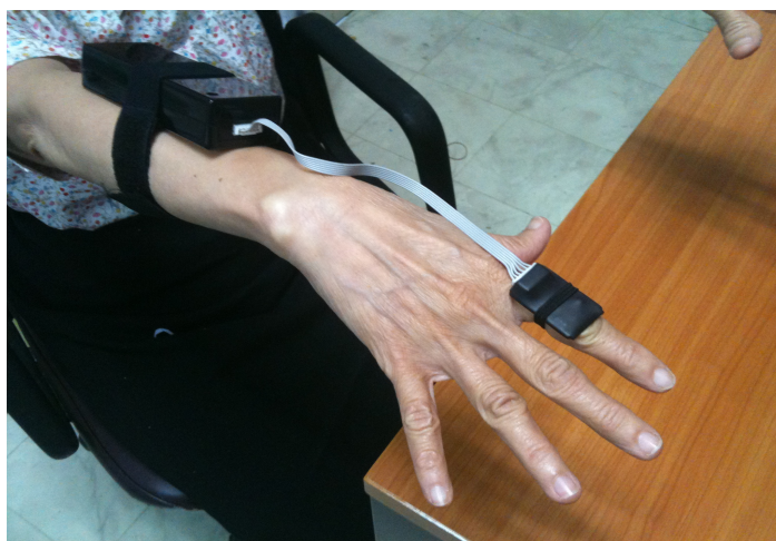
รูปที่ 1.1 แสดงชุดรับสัญญาณของเครื่องตรวจวัดการสั่น และการติดชุดรับสัญญาณกับผู้ป่วย
