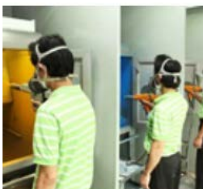
ภาพที่ 3.9 การเตรียมแผ่นชิ้นงาน โดยการพ่นและอบเพื่อตรวจสอบคุณภาพพื้นผิวเคลือบ
