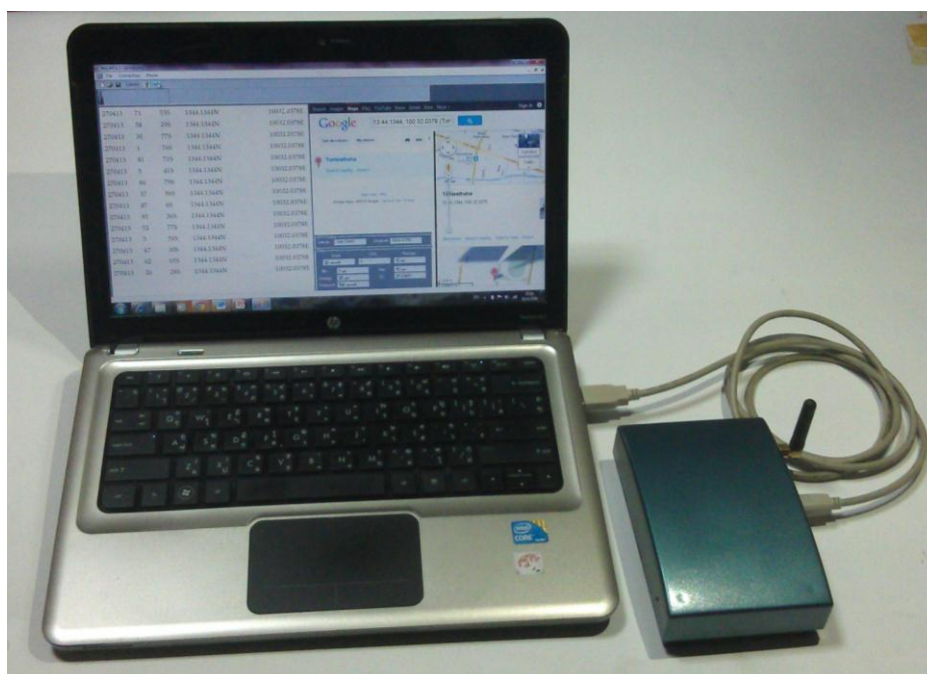
ภาพที่ 3.33 ระบบเก็บข้อมูลกลางอันประกอบด้วย คอมพิวเตอร์ และ โมดูล GPRS
