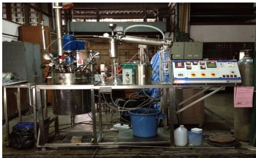
รูปที่ 3.1 เครื่องปฏิกรณ์แบบกะขนาด 20 ลิตร (AmAr reactor)
