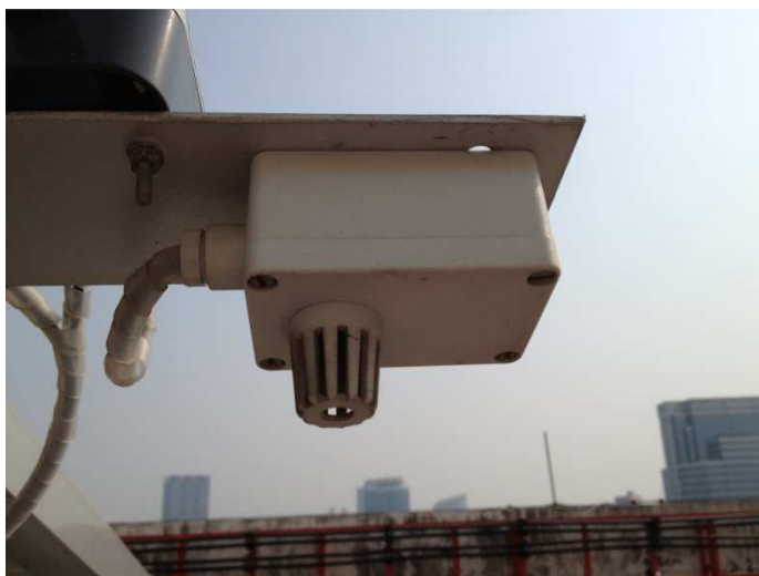
ภาพที่ 7.6 เซนเซอร์ตรวจวัดอุณหภูมิของสิ่งแวดล้อม และอาร์เรย์เซลล์แสงอาทิตย์
