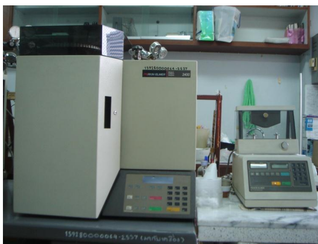
รูปที่ 3.5 เครื่องวิเคราะห์ธาตุ (Elemental Analyzer, PerkinElmer PE2400 series II)
