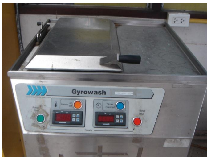
รูปที่ 3.8 เครื่องทดสอบความคงทนของสีต่อการซัก (Gyrowash)
