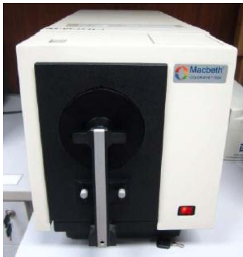
รูปที่ 3.7 เครื่องวัดสี (Reflectance spectrophotometer, Macbeth Color-Eye 7000)
