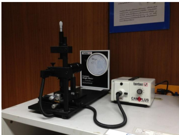
รูปที่ 3.11 เครื่องวัดมุมสัมผัส (Contact angle meter, CAM-PLUS Tantec)
