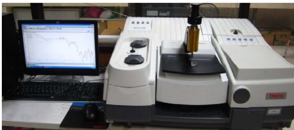
รูปที่ 3.4 เครื่องฟูเรียร์ทรานสฟอร์มอินฟราเรดสเปกโทรมิเตอร์ (FTIR)
