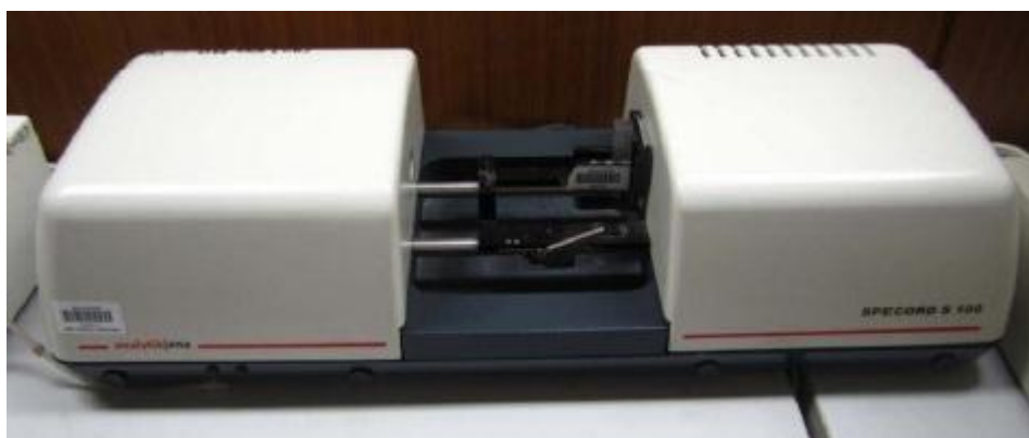
รูปที่ 3.6 เครื่อง UV-VIS spectrophotometer (Specord S100)
