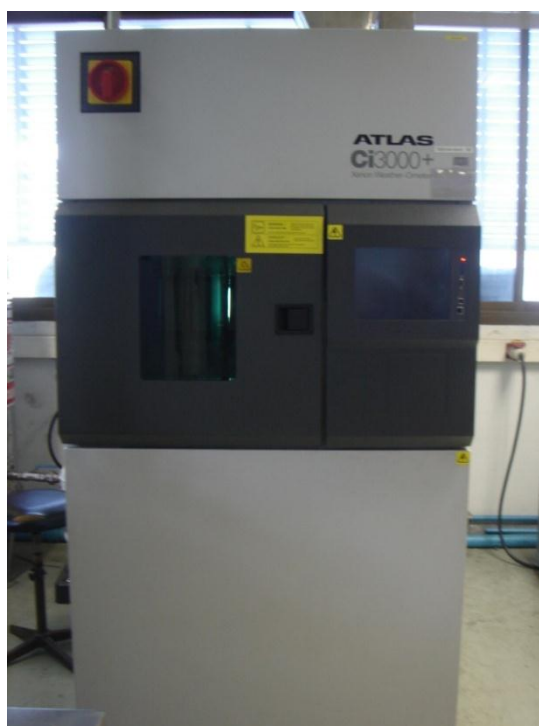
รูปที่ 3.9 เครื่องทดสอบความคงทนของสีต่อแสง (Atlas Xenon Arc Weather-Ometer Model Ci 3000+)
