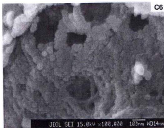
รูปที่ 2.6 แสดงภาพถ่าย SEM พื้นผิวของคาร์บอนไฟเบอร์โอเจลที่ใช้ไตรเมทิลสเทียริลแอมโมเนียมคลอไรด์ เป็นสารลดแรงตึงผิว และน้ำเป็นตัวทำละลาย [11]
