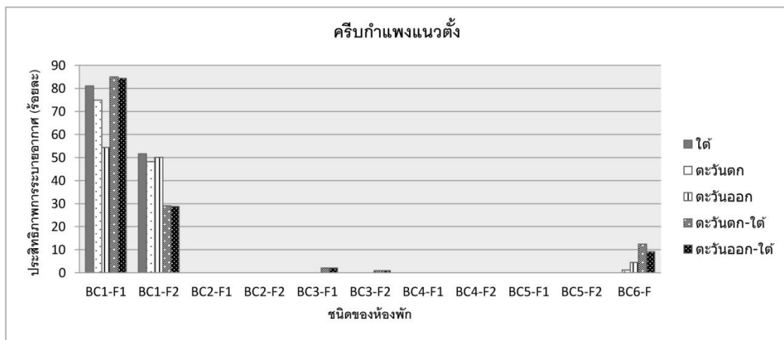
รูปที่ 4.7 แสดงผลประสิทธิภาพการระบายอากาศ เมื่อคำนึงถึงปัจจัยการติดตั้งcribผนัง
