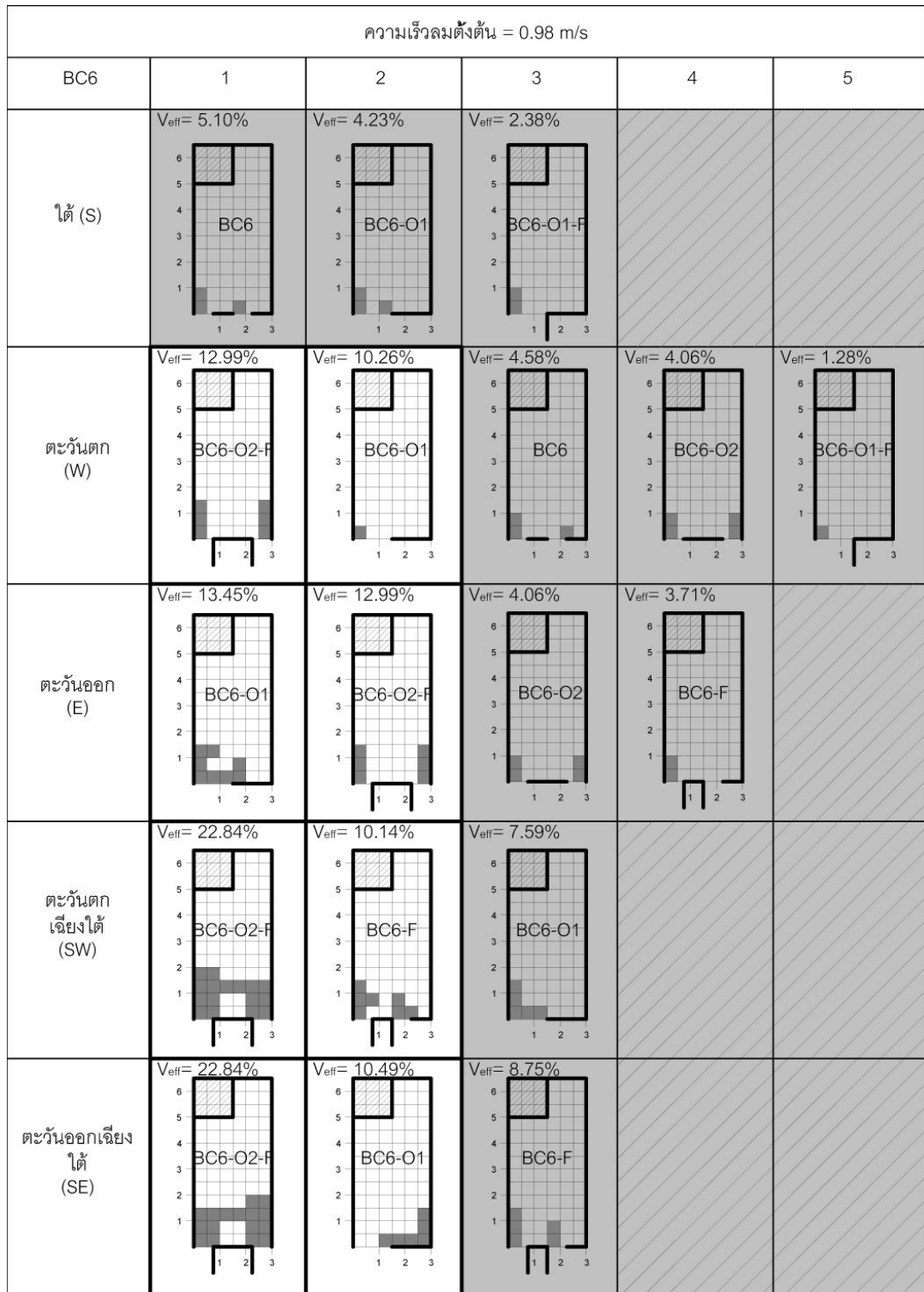
ตารางที่ 5.11 สรุปประสิทธิภาพการระบายอากาศของห้องพักที่ทำให้ส่วนพักอาศัยมีความเร็วลมเฉลี่ยตั้งแต่ 0.10 เมตร/วินาที ของห้องพักที่ไม่มีระเบียง (BC6) เมื่อความเร็วลมตั้งต้น 0.98 เมตร/วินาที
