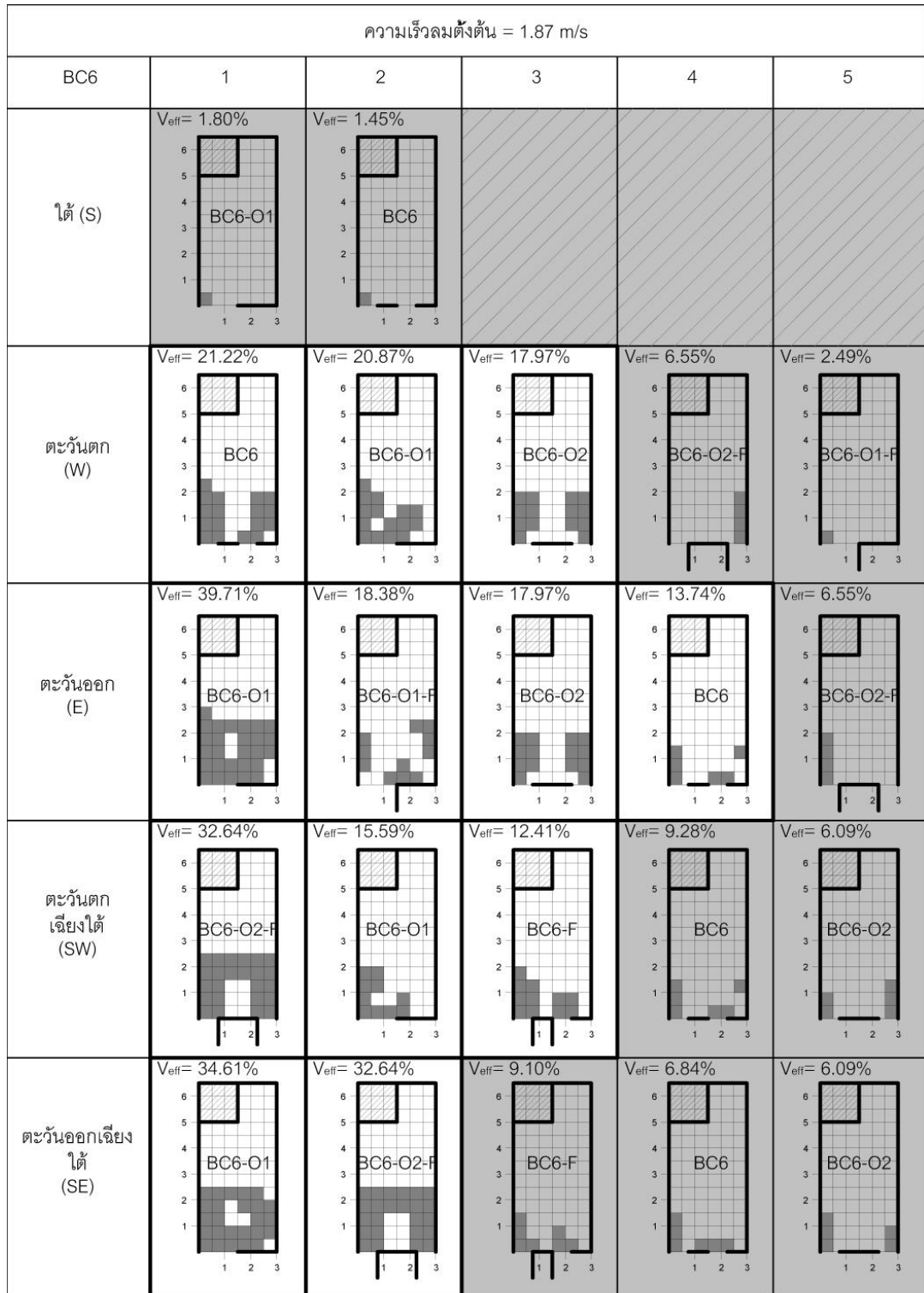
ตารางที่ 5.12 สรุปประสิทธิภาพการระบายอากาศของห้องพักที่ทำให้ส่วนพักอาศัยมีความเร็วลมเฉลี่ยตั้งแต่ 0.10 เมตร/วินาที ของห้องพักที่ไม่มีระเบียง (BC6) เมื่อความเร็วลมตั้งต้น 1.87 เมตร/วินาที
