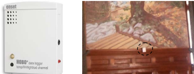
ภาพที่ 3.2 อุปกรณ์บันทึกความสว่างสะสม Hobo light รุ่น U12-021
