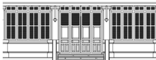
ภาพที่ 5.14 หน้าต่างบานเกรดตรงระเบียบห้องบรรทมเจ้ามหาชีวิต
