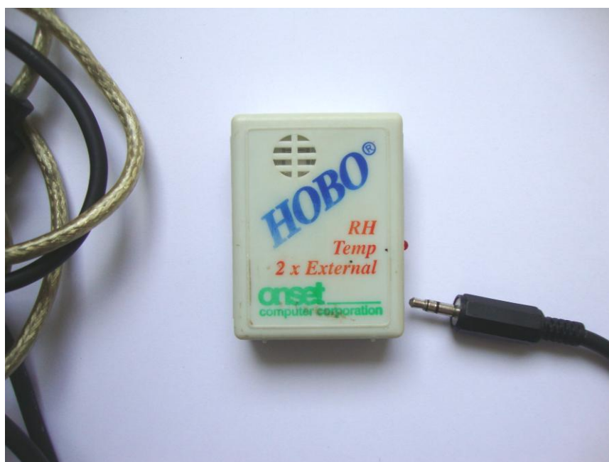
ภาพที่ 3.1 อุปกรณ์ data logger สำหรับเก็บข้อมูลอุณหภูมิอากาศ และความชื้นสัมพัทธ์ ยี่ห้อ HOBO รุ่น multi-channel reusable data logger HO8-007-02
