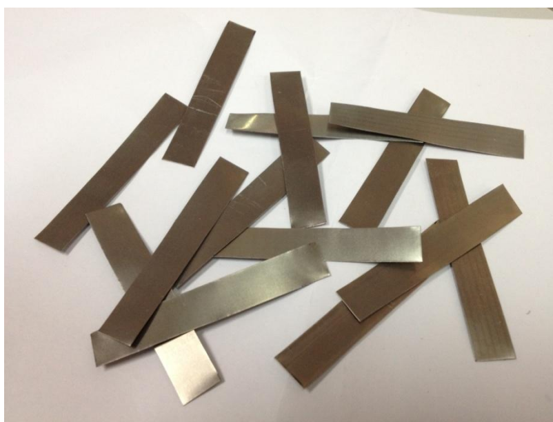
ภาพที่ 3.3 แผ่นไทเทเนียมที่ผ่านกระบวนการดัด
