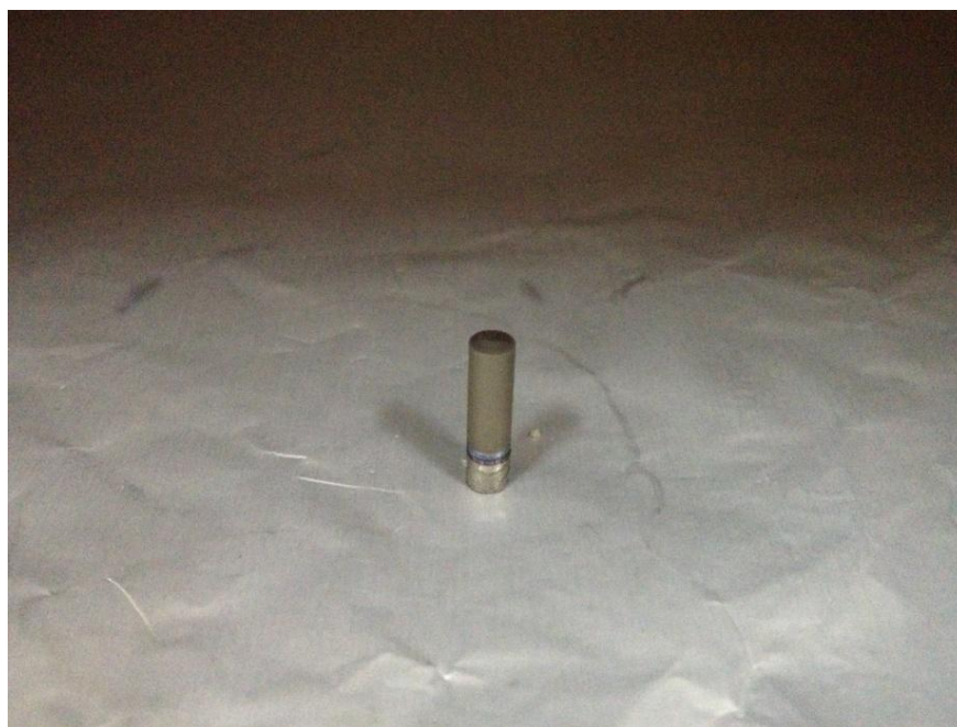
ภาพที่ 4.10 ทิศทางการวางแท่งไทเทเนียมในเตาอบ
