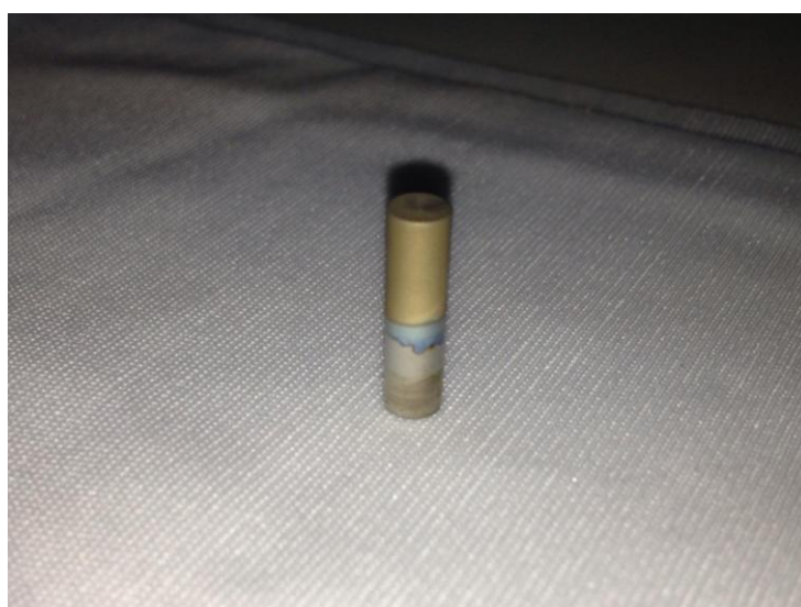
ภาพที่ 4.14 แท่งไทเทเนียมที่ผ่านกระบวนการอะโนไดซ์เซชันโดยใช้เครื่องปั่นกวนสารละลายด้วยความเร็วต่ำ 60 รอบต่อนาที
