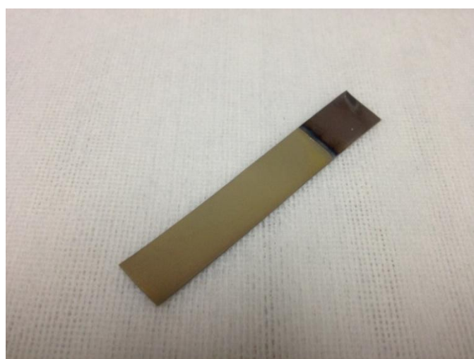
ภาพที่ 3.28 แผ่นไทเทเนียมขนาดกว้าง 1 เซนติเมตร ยาว 6 เซนติเมตร ที่ผ่านกระบวนการอะโนไดซ์เซชัน
