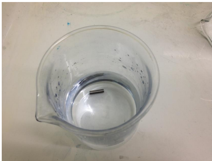
ภาพที่ 4.2 การทำความสะอาดแท่งไทเทเนียมด้วย Acetone และ IPA
