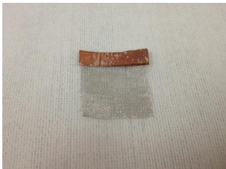
ภาพที่ 3.15 โลหะพลาตินัมที่ใช้เป็นขั้วแคโทด
