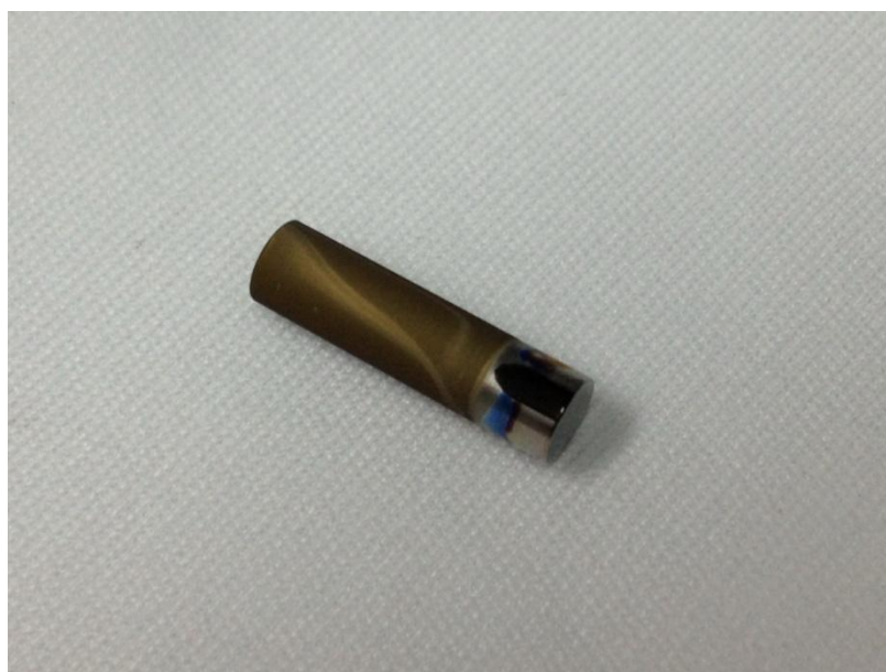
ภาพที่ 4.11 ชั้นไทเทเนียมไดออกไซด์บนแท่งไทเทเนียมที่บางกว่าในบริเวณอื่นๆ
