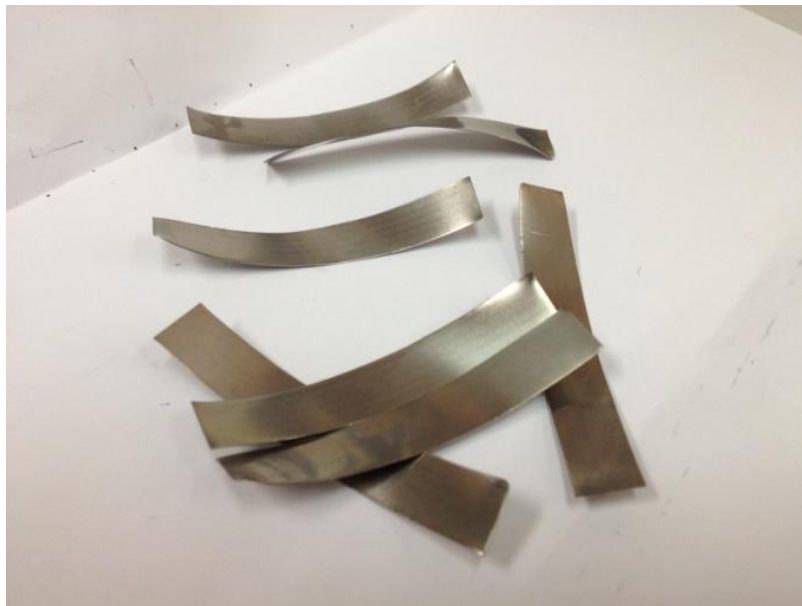
ภาพที่ 3.2 แผ่นไทเทเนียมที่ผ่านกระบวนการตัด
