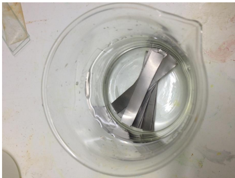
ภาพที่ 3.4 การทำความสะอาดแผ่นไทเทเนียมด้วย Acetone และ IPA
