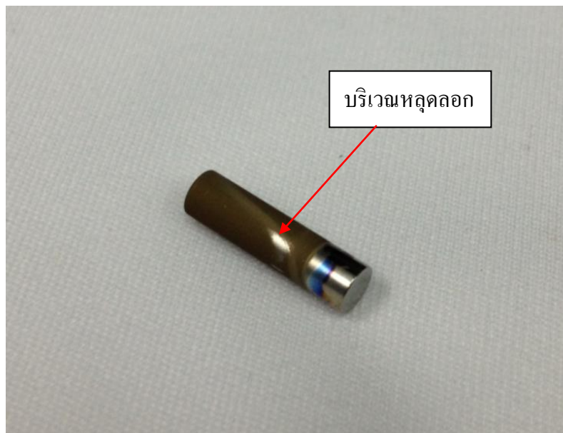
ภาพที่ 4.12 บริเวณที่ขึ้นไทเทเนียมไดออกไซด์บนแท่งไทเทเนียมหลุมดอก
