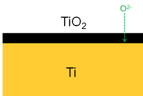
ภาพที่ 2.6 รูปแบบการเกิดชั้นออกไซด์ของ \text{TiO}_2 บนแผ่นไทเทเนียม
