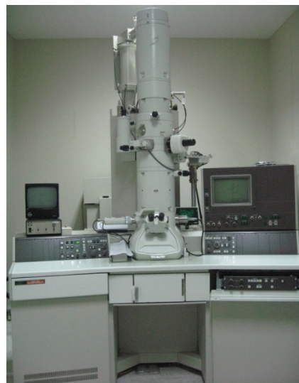
รูปที่ 3.4 กล้องจุลทรรศน์แบบส่องผ่าน Transmission Electron Microscope (TEM) รุ่น JEM-2010 ศูนย์บริการวิทยาศาสตร์และเทคโนโลยี มหาวิทยาลัยเชียงใหม่
