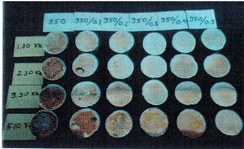
รูปที่ 2.5 ผิวชิ้นงานเงิน 95% ผสมซิลิกอน 0.1 - 0.5% และ ทองแดง 4.5 - 4.9 % ผ่านการทดสอบกันหมองในบรรยากาศ H 2 S ที่เวลา 1.30 - 1.50 ชม.[16]
