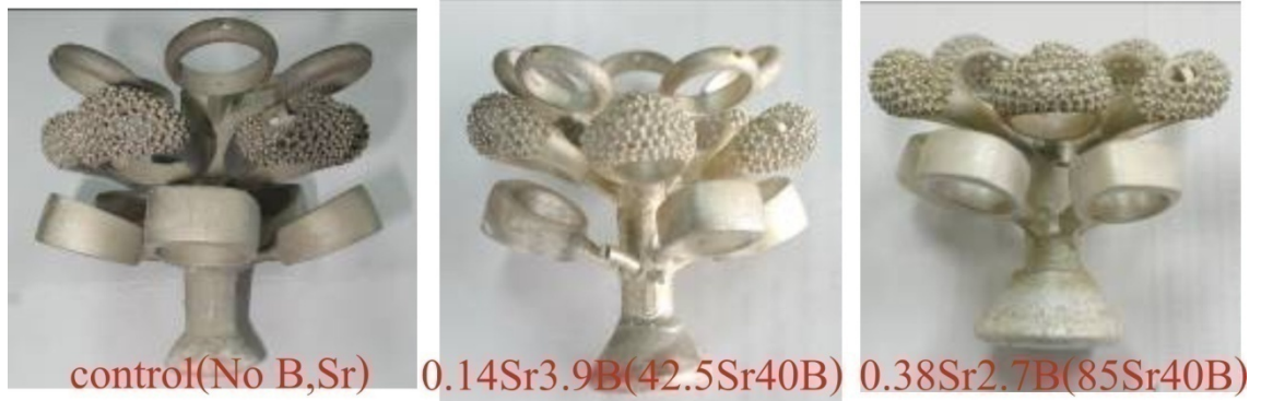
รูปที่ 4.8 ผิวหลังหล่อของชิ้นงานเงินสเตอร์ลิงเติม โบรอน และ สตรอนเชียม
