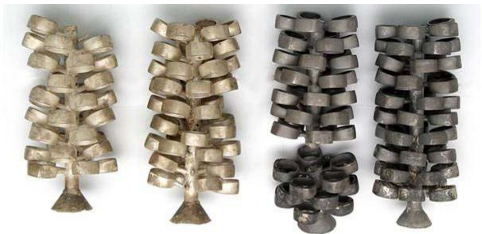
รูปที่ 2.4 การเปรียบเทียบผิวหลังการหล่อและล้างปูนระหว่างเงินสเตอร์ลิงผสมทองแดงสังกะสี และซิลิกอน (สองต้นทางซ้าย) กับ เงินสเตอร์ลิงผสมทองแดง ซิลิกอน (สองต้นทางขวา) [10]
