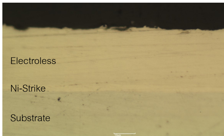
ภาพที่ 4.1 ภาพตัดขวางของชั้นเคลือบที่ชุบแบบไม่ใช้ไฟฟ้า
