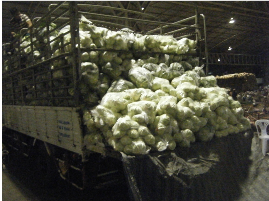
รูปที่ 3-17 แสดงรถบรรทุกผักกะหล่ำปลีบรรจุถุงพลาสติกขนาด 6 ล้อไม่มีตู้ควบคุมอุณหภูมิ
