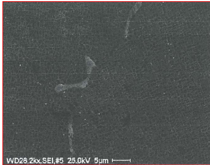
รูปที่ 2.3 ตะกอนคาร์ไบด์ที่บริเวณขอบเกรนเนื้อพื้นแกมมา พบในโลหะผสมพิเศษชนิดเนื้อพื้น นิกเกิล เกรด GTD-111 [5]
