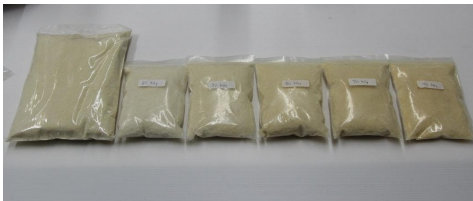
รูปที่ 3.2 โคโคซานผงที่ได้รับการฉายที่ปริมาณรังสี 0 10 30 50 70 และ 90 kGy ตามลำดับ (ซ้ายไปขวา)
