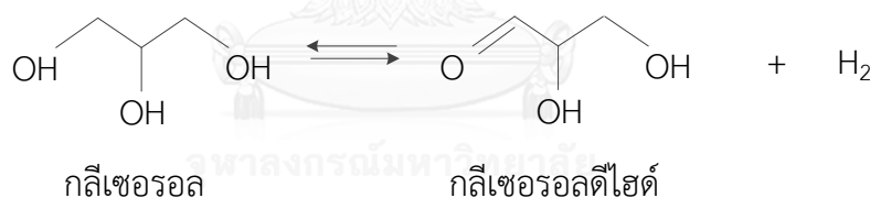
รูปที่ 4.19 ปฏิกิริยาดิไฮโดรจีเนชันของกลีเซอรอล
