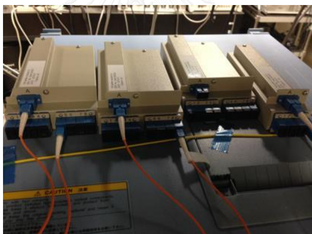
รูปที่ 1.5 ตัวแยกแสงชนิดท่อนำคลื่นรวมของบริษัท Fujikura
