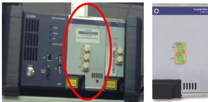
รูปที่ 1.8 ตัวกรองสัญญาณเฉพาะย่านความถี่แสงแบบปรับได้ของบริษัท JDSU
