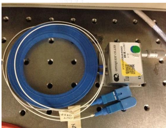
รูปที่ 2.26 ตัวกรองสัญญาณเฉพาะย่านความถี่แสงแบบปรับได้ของบริษัท OPTOQUEST
