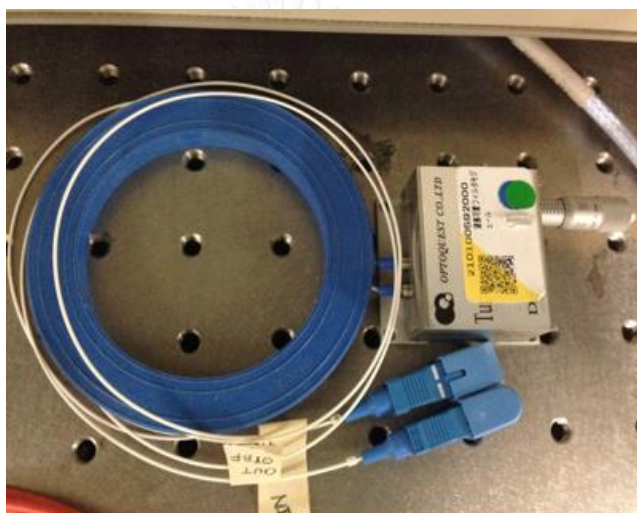
รูปที่ 1.9 ตัวกรองสัญญาณเฉพาะย่านความถี่แสงแบบปรับได้ของบริษัท OPTOQUEST
