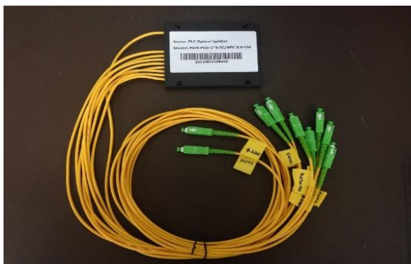
รูปที่ 2.17 ตัวแยกแสงชนิดท่อนำคลื่นรวมของบริษัท Huatai
