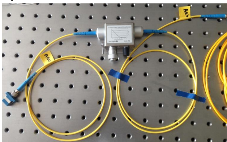
รูปที่ 2.29 ตัวลดทอนกำลังแสงแบบปรับค่าได้ของบริษัท OPTOQUEST
