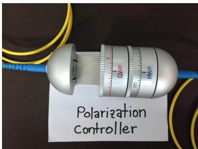
รูปที่ 2.10 ตัวควบคุมโพลาไรเซชัน (Polarization Controller, PC)
