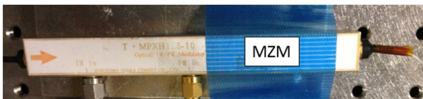
รูปที่ 1.3 ตัวส่งสัญญาณแสงแบบมัค-เซนเดอร์
