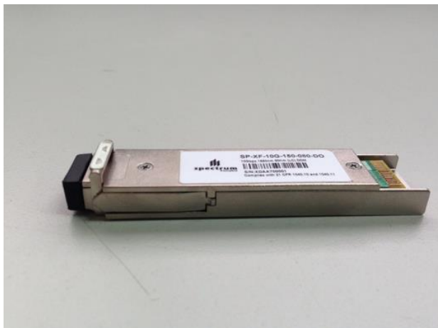
รูปที่ 1.2 ตัวรับส่งสัญญาณแสง
