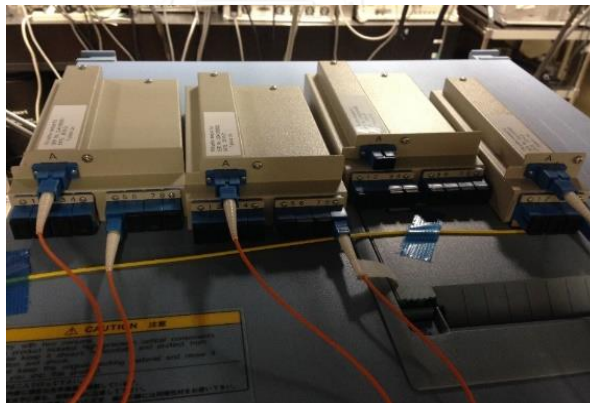
รูปที่ 2.16 ตัวแยกแสงชนิดท่อนำคลื่นรวมของบริษัท Fujikura
