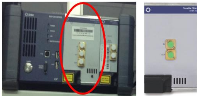
รูปที่ 2.25 ตัวกรองสัญญาณเฉพาะย่านความถี่แสงแบบปรับได้ของบริษัท JDSU
