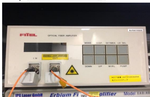
รูปที่ 1.7 ตัวขยายอีดีเอฟเอของบริษัท Fitel
